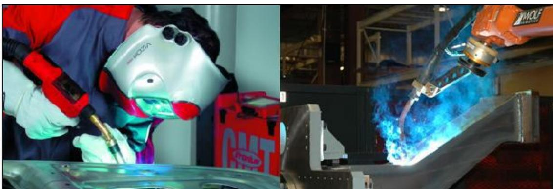
Figura 5: Tipos de aplicação do processo GMAW manual e automático.
