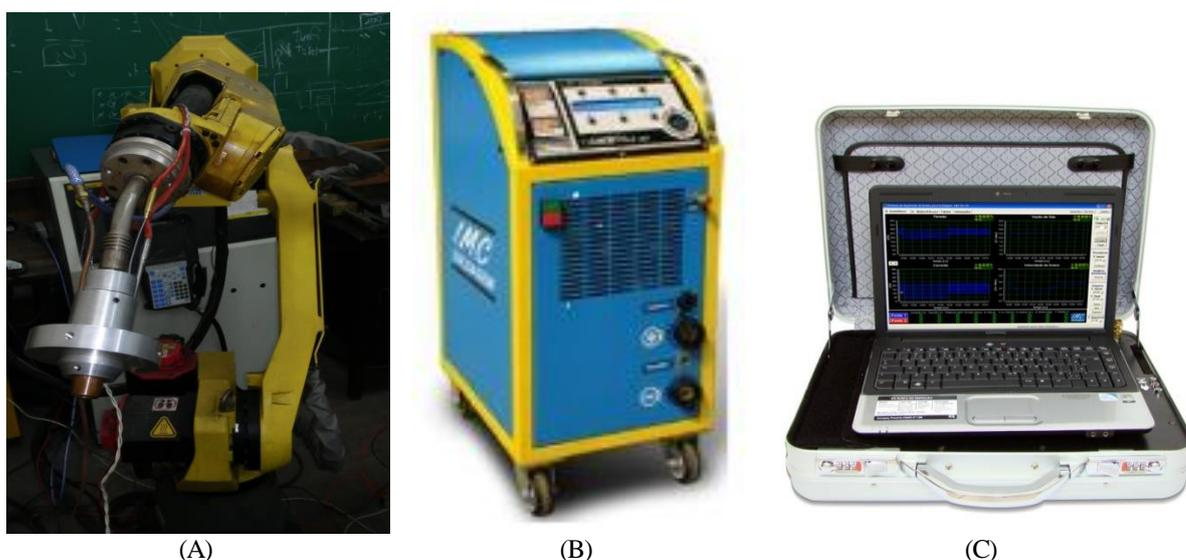
Figura 17: (A) Robô de soldagem FANUC, (B) Fonte de soldagem IMC e (C) Sistema aquisição de dados da soldagem IMC.
