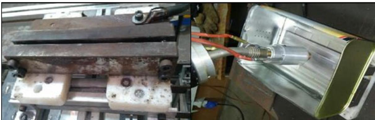
Figura 16: Em A, a morsa de fixação e em B, o corpo de prova no interior da cuba de retenção de respingos e salpicos.
