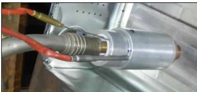
Figura 20: Dispositivo de aquecimento do CO<sub>2</sub> adaptado a tocha GMAW.
