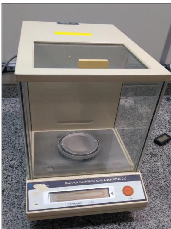
Figura 27: Balança de precisão
