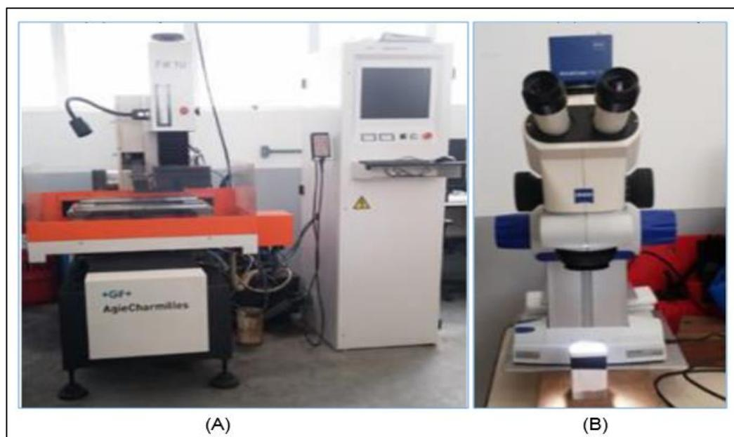
Figura 18: (A) Máquina de eletro erosão a fio Charmilles (B) Estereoscópio Zeiss
