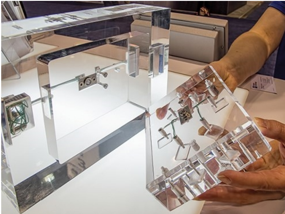
Figura 16: Demonstrativo de sensores num molde acadêmico. Fonte: Kistler (2015).
