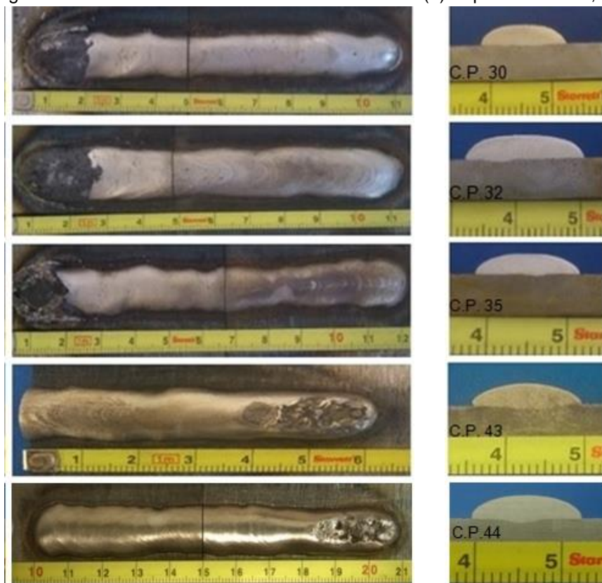
Figura 25 – Cordões de solda realizados na fase 2: (a) Aspectos visuais, (b) Macros
