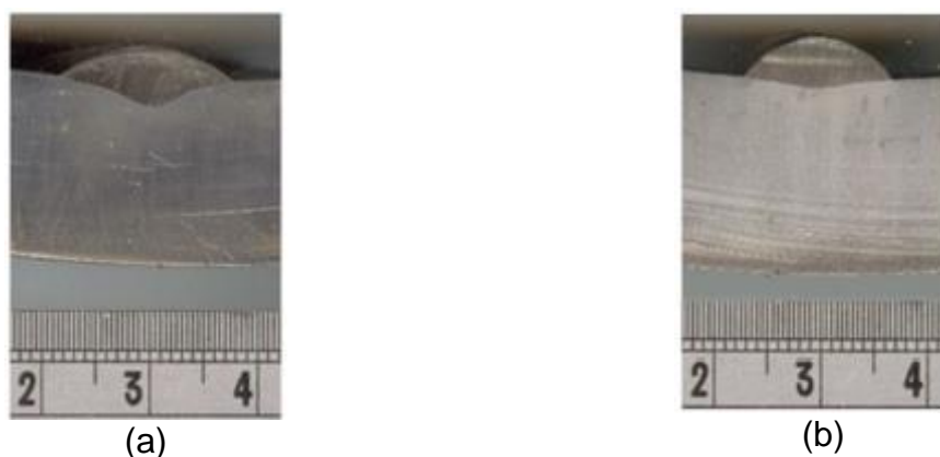
Figura 14 – Influência da DBCP na macro do cordão com velocidade de alimentação constante em 7 m/min, velocidade de soldagem em 22 cm/min e tensão em 40 V. (a) DBCP de 20 mm, (b) DBCP de 30 mm.
