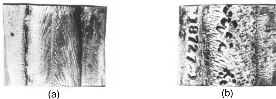
Figura 7 – Influência da camada de fluxo na qualidade do cordão, (a) altura correta, (b) pouco fluxo.
