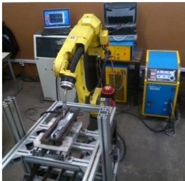
Figura 16 – Bancada de ensaios do processo SAW.
