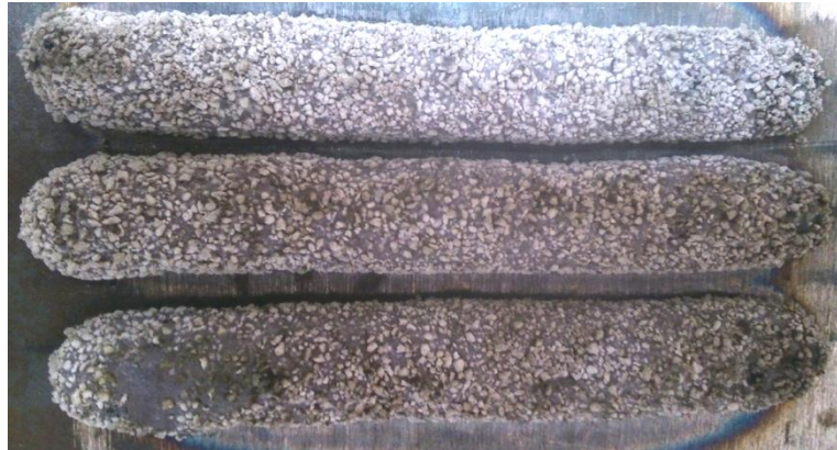
Figura 29 – Produção dos cordões ímpares da primeira etapa do novo método de revestimento.
