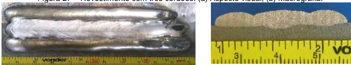
Figura 27 – Revestimento com três cordões: (a) Aspecto visual; (b) Macrografia.
