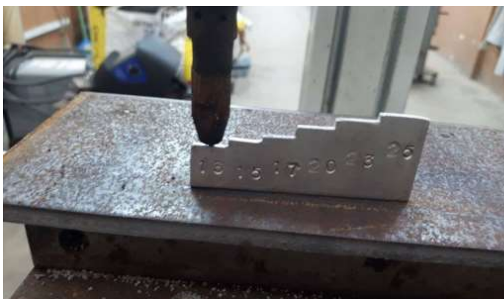
Figura 22- Medição da DBCP utilizando o calibre fornecido pelo laboratório de soldagem
