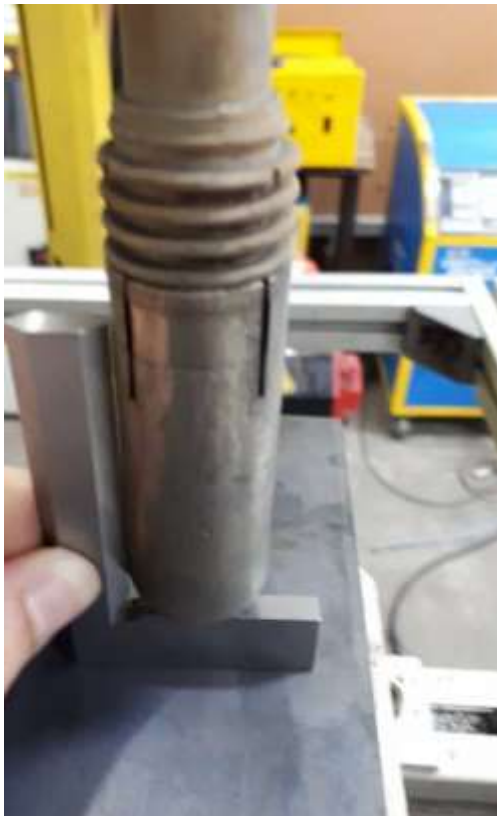
Figura 21- Medição com esquadro com fio
