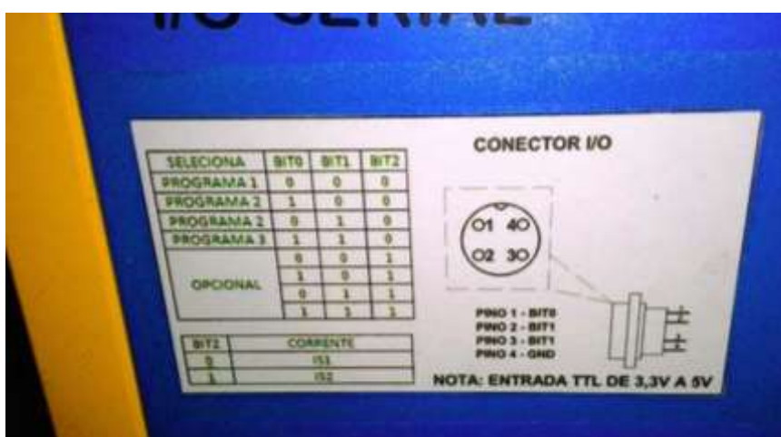
Figura 11- Entrada conector TLL da fonte IMC DIGIPLUS
