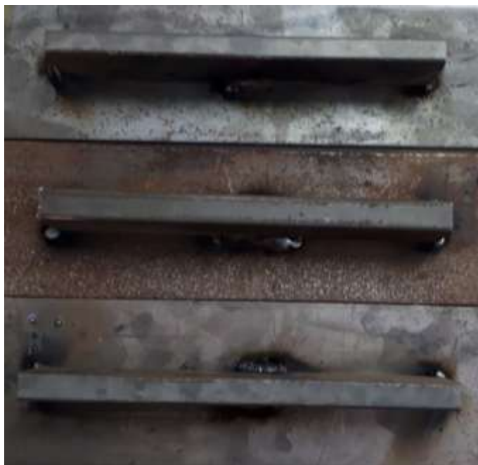
Figura 25- Preparação corpos de prova para os ensaios MIG/MAG pulsado e MIG/MAG convencional
