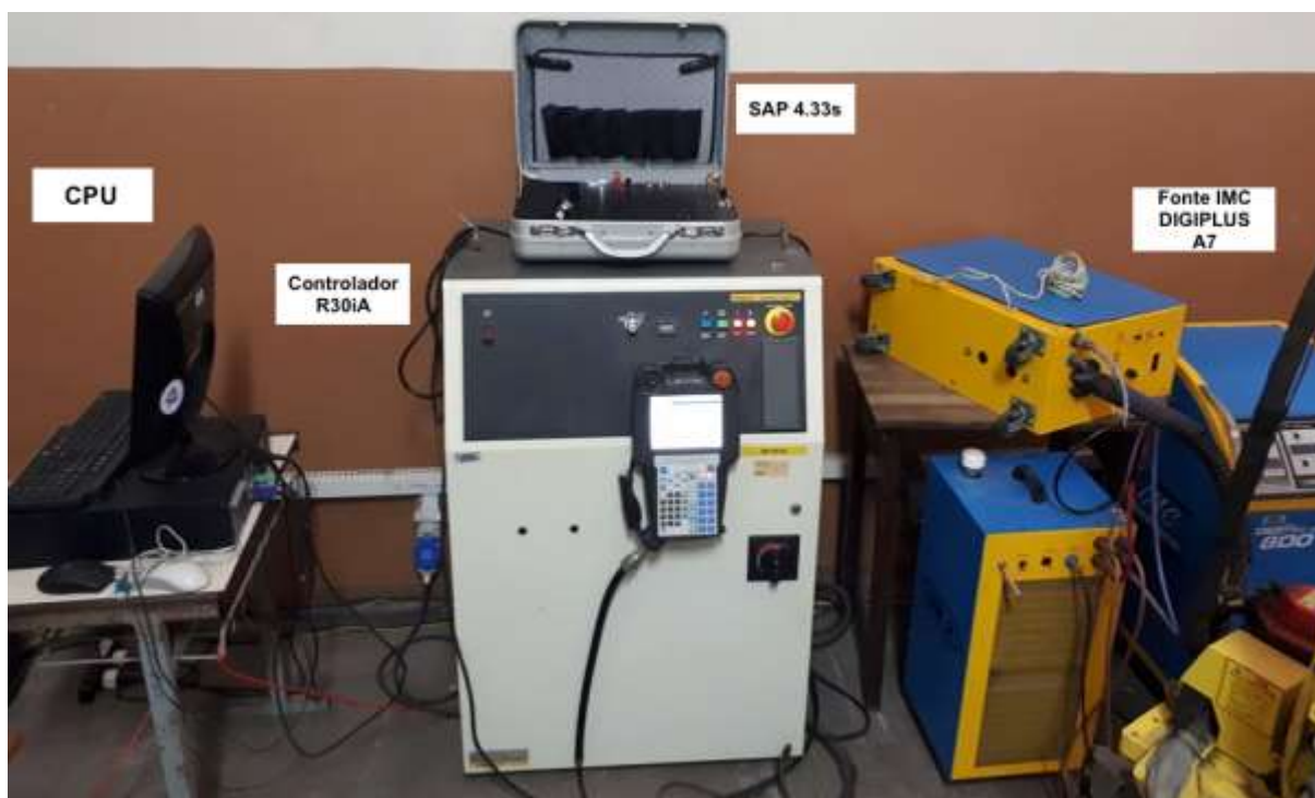
Figura 9- Bancada do laboratório de soldagem do IFSC/ Florianópolis
