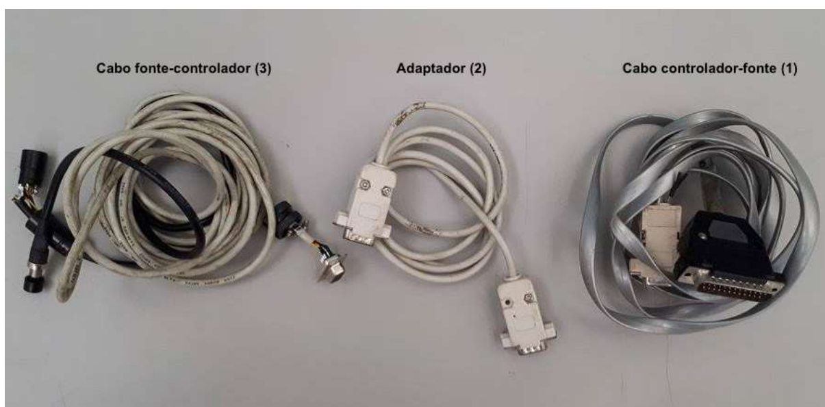
Figura 15- Cabos confeccionados para comunicação via RS232
