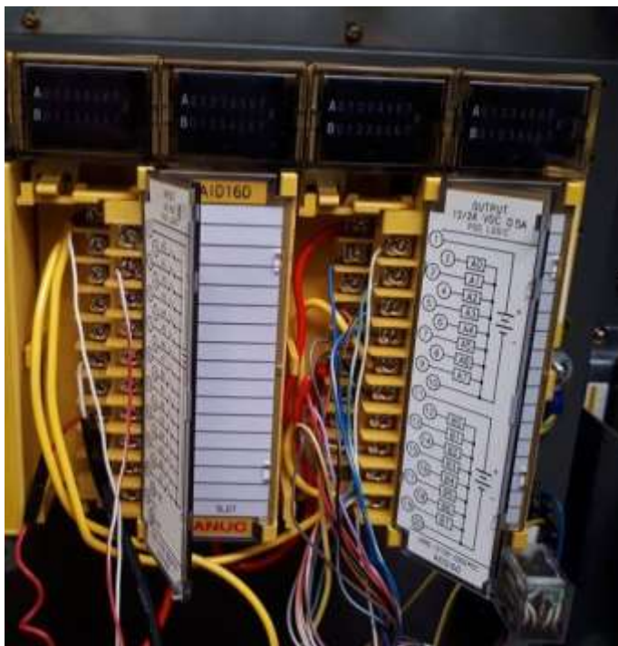
Figura 10- Módulos de entradas e saídas digitais
