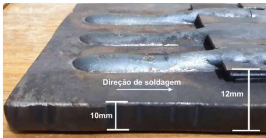
Figura 39- Altura das chapas para o controle do processo
