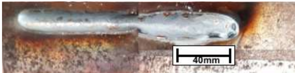
Figura 37- Ensaio MIG/MAG convencional com controle sem os limites de correção corretos
