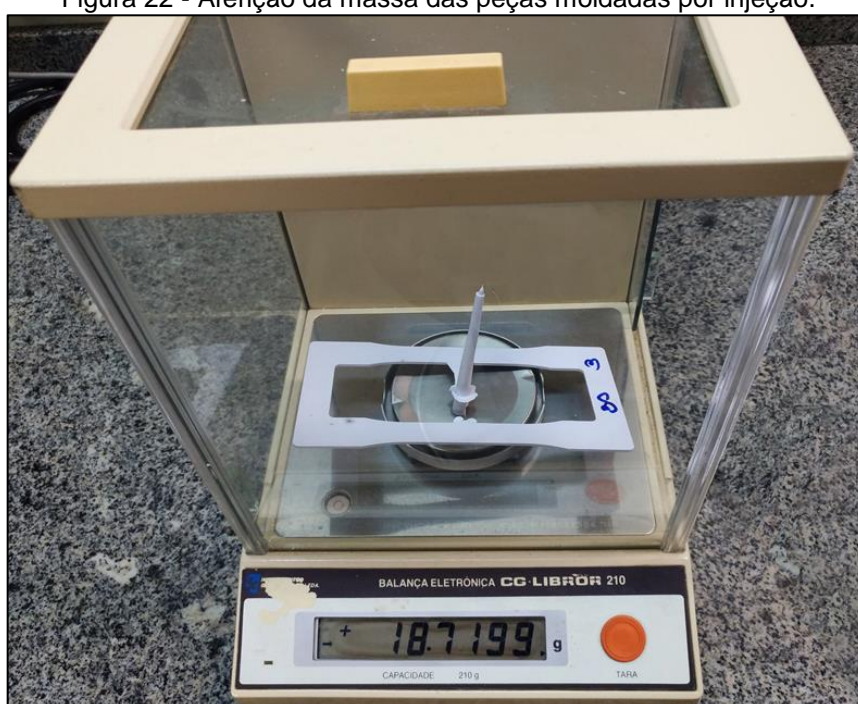
Figura 22 - Aferição da massa das peças moldadas por injeção.
