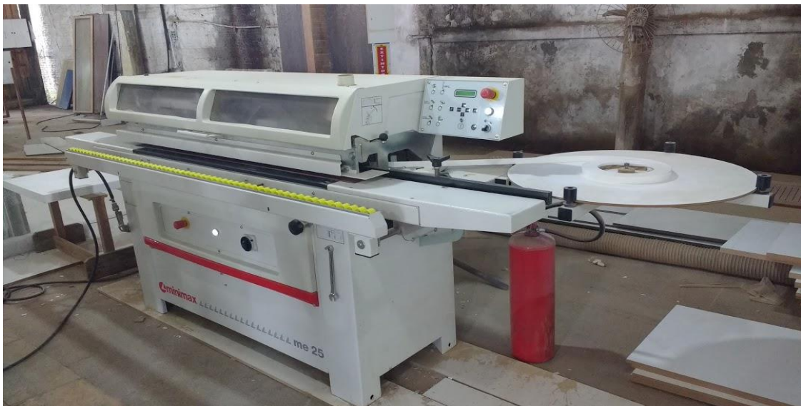
Figura 6 - Maquinário utilizado para colar fitas de borda em MDF da Móveis da Ilha.
