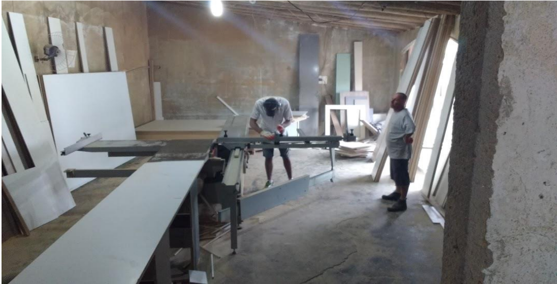
Figura 5 - Corte do MDF: início da produção dos móveis sob medida na Móveis da Ilha.
