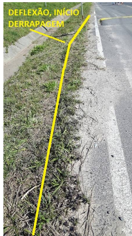
Figura 12 – Detalhe trilha deixada pelos pneus do lado esquerdo do veículo 01
