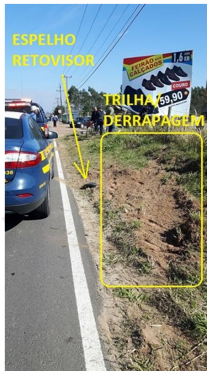
Figura 16 – Marcas de derrapagem na terra (início do capotamento).
