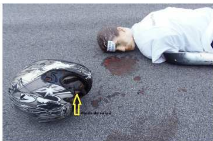
Fotografia 8 – marca de fluido dentro do capacete e falta de viseira
