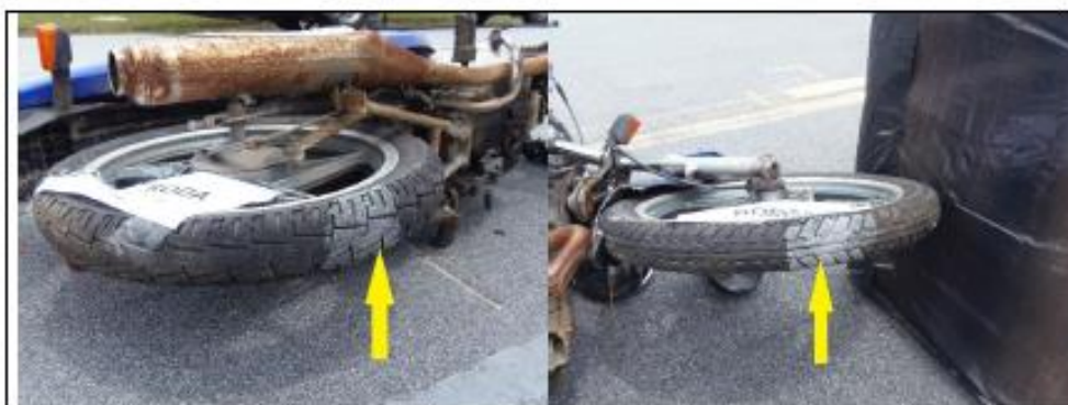
Figura 8 – Estado de conservação dos pneumáticos com destaque para a marca de atritamento com o solo.
