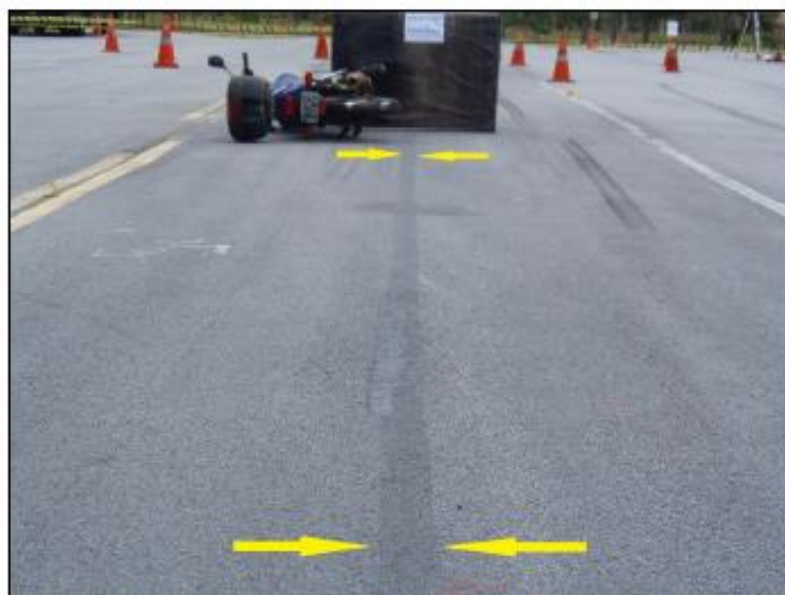
Figura 6 – Posição final do veículo e marca de frenagem em destaque entre as setas.
