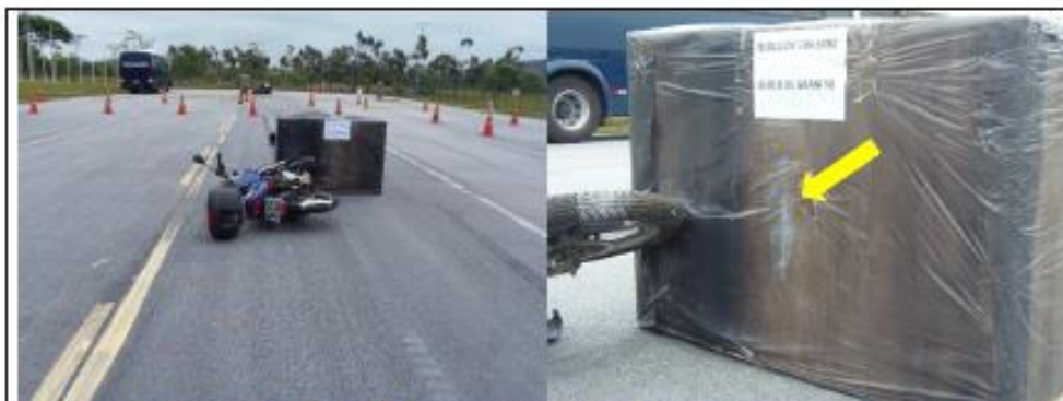
Figura 3 – Veículo 1 e bloco de granito. Em destaque a marca de colisão do veículo com o bloco, evidenciando o sítio de colisão.
