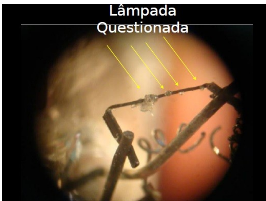
Figura 10: Exemplo de filamento oxidado com vidro fundido
