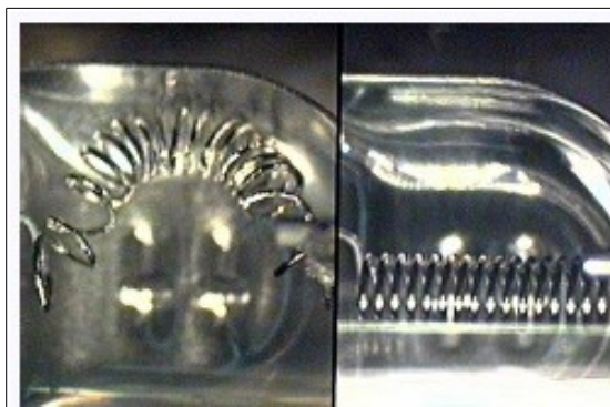
Figura 8: Filamento de farol baixo, esquerda, em comparação com filamento novo, direita. Região do impacto
