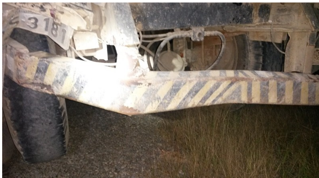
Figura 13: Visão do para-choque traseiro e pneus em mau estado
