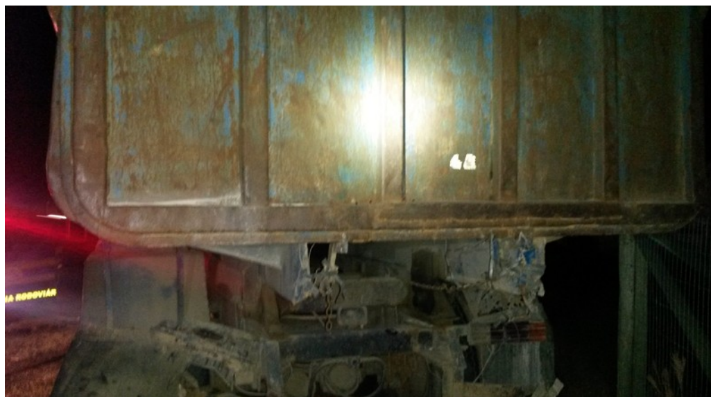
Figura 12: Lanternas traseiras do caminhão envolvido no acidente
