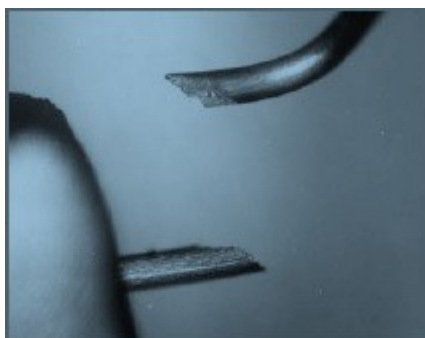
Figura 11 – Exemplo de fratura de filamento a frio
