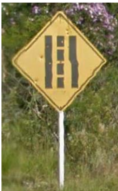
Figura 24 - Placa não classificada, com sinal A-21c – “Estreitamento de pista à direita” acrescido de uma linha pontilhada no centro
