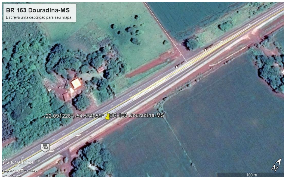
Figura 18 - Ponto Final de Faixa Adicional - Modelo com canteiro ou obstáculo central - BR 163 MS km 287D
