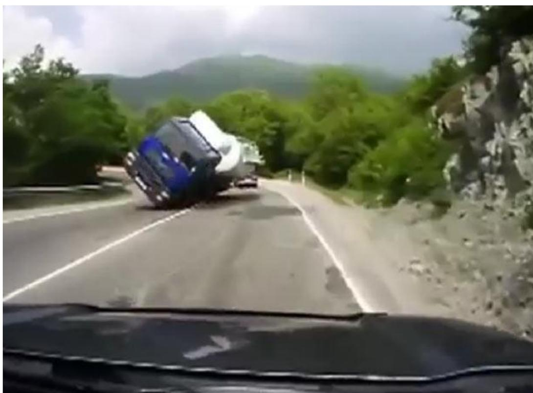
Figura 31. Caminhão sendo tombado pela força centrífuga
