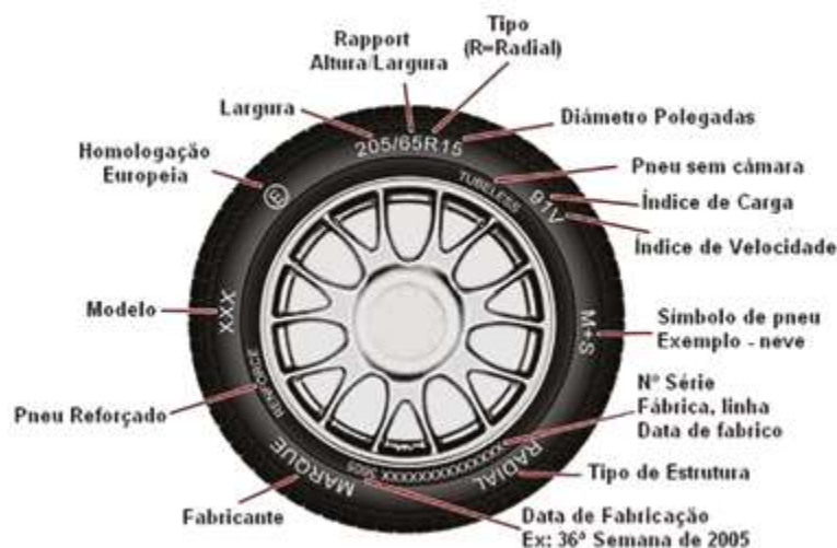
Figura 1- Nomenclatura do pneu
