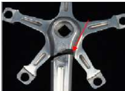
Figura 5: Trinca em ponto concentrador de tensão
