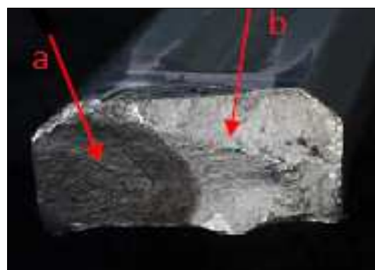
Figura 6: Secção da peça fraturada inicial e final
