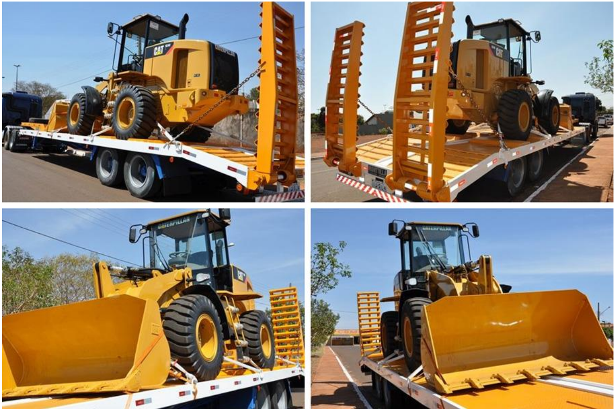
Figura 21- Fixação direta através de dispositivos de fixação
