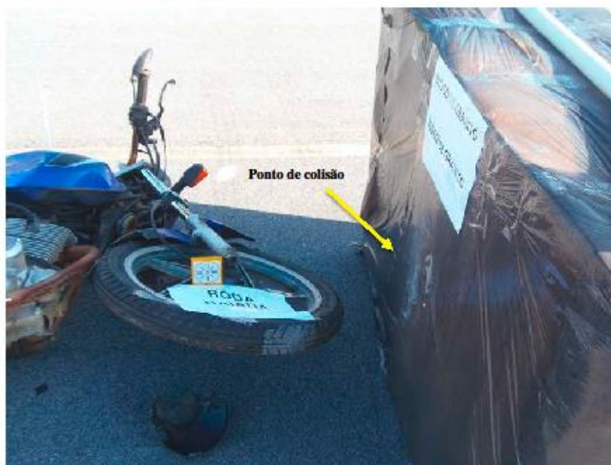
Figura 10 – Detalhe da dianteira do veículo V2 e do ponto de colisão com o bloco de granito
