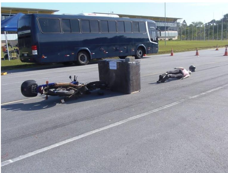
Figura 14 – Colisão de motocicleta com bloco de granito
