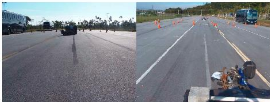
Figura 05 – Detalhe da marca de frenagem de V2, vista de dois ângulos, no sentido decrescente e no crescente
