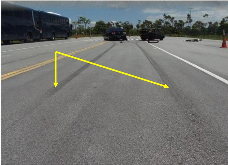
Fig. 25 – Extensão da frenagem de V2 até a colisão - 15,51m.
