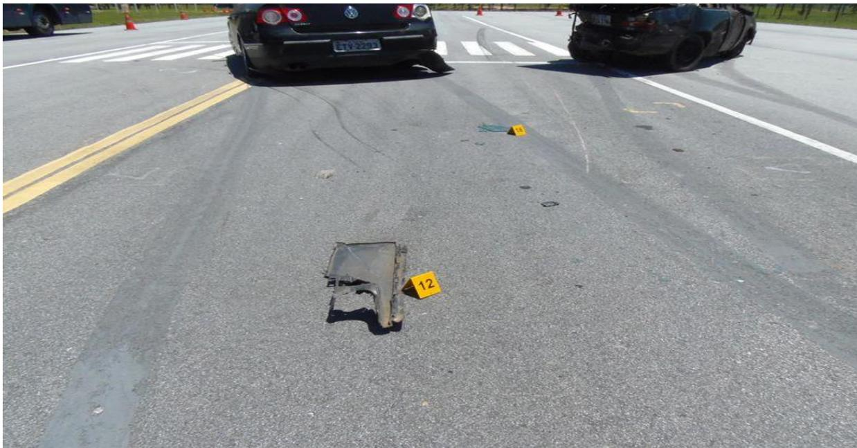
Fig. 10 – Fragmento do para choque dianteiro de V2.
