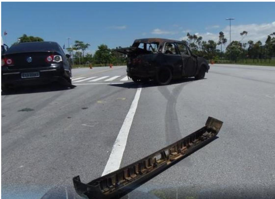
Fig. 9 – Para choque traseiro de V1.
