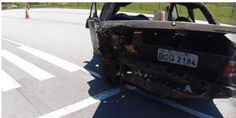
Fig. 14 – Amassamento na parte traseira de V1.
