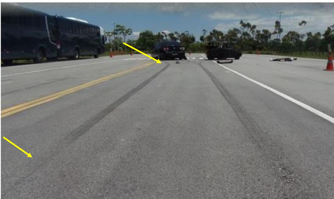
Fig. 19 - Extensão da frenagem de V2.
