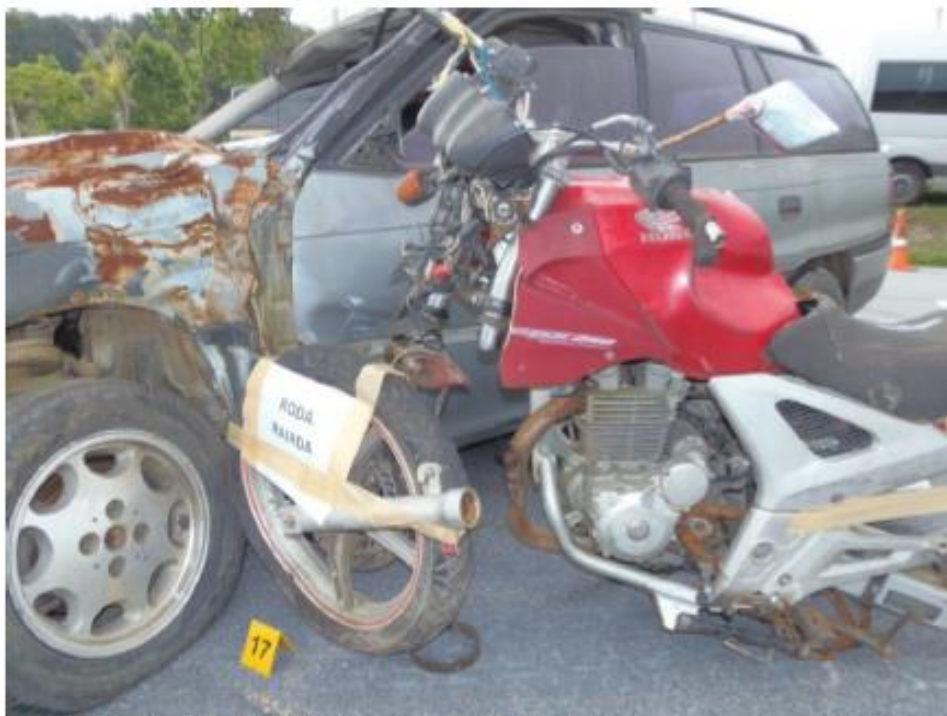
Figura 18: Porção anterior (PA) e lateral anterior esquerda (LAE) de V2 com empenamento e redução da distância entre eixos.
