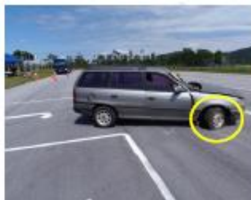
Figura 45: Detalhe do esterçamento da roda dianteira direita voltada para à esquerda
