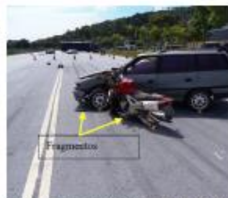
Figura 12: Fragmentos como consequência das manobras do veículo acidentado.
