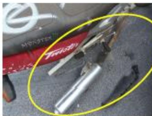
Figura 43: Detalhe da deflexão da marca de pneumático, fricção metal X asfalto e concentração de fragmentos móveis
