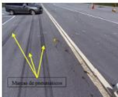
Figura 15: Marcas de pneumáticos sem relação com o evento em estudo.
