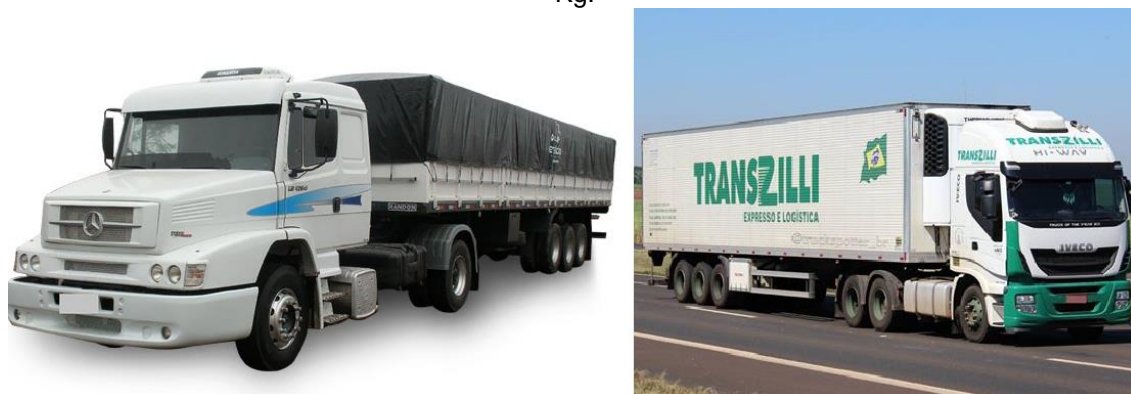
Figura 11 – Carreta com cinco eixos, capacidade de carga de 41.500 Kg e carreta com seis eixos, capacidade de carga 45.000 Kg.
