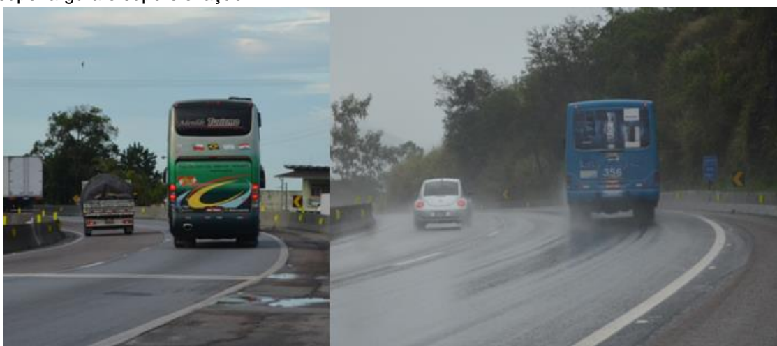
Figura 13 – Curva Km 192, sem superlargura e superelevação. Curva Km 191 com superlargura e superelevação.
