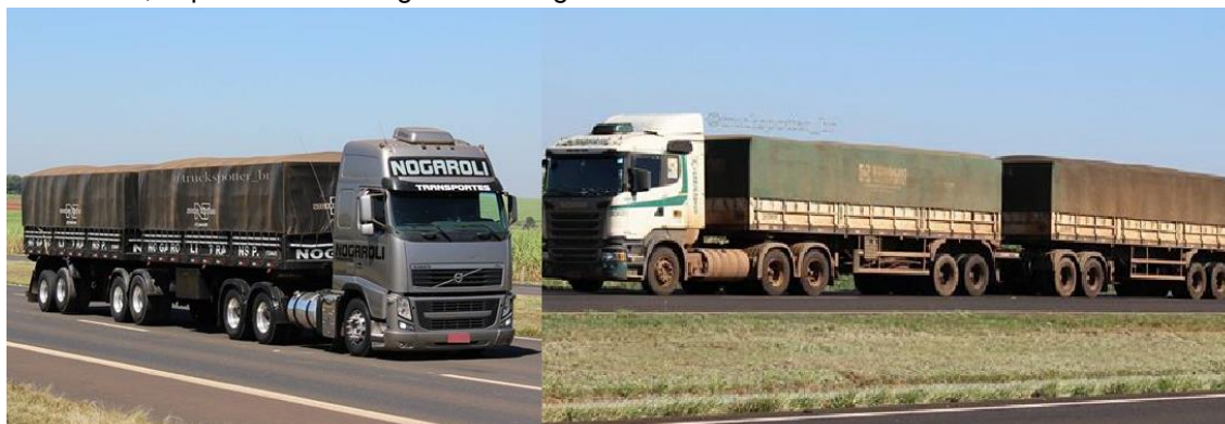
Figura 12 – Carreta com sete eixos, capacidade de carga de 57.000 Kg e carreta com nove eixos, capacidade de carga 74.000 Kg.
