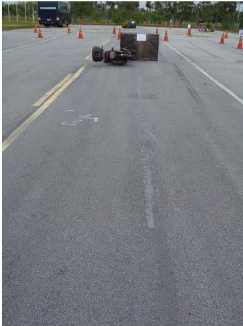
Fotografia 7 – Marca de frenagem do V1
