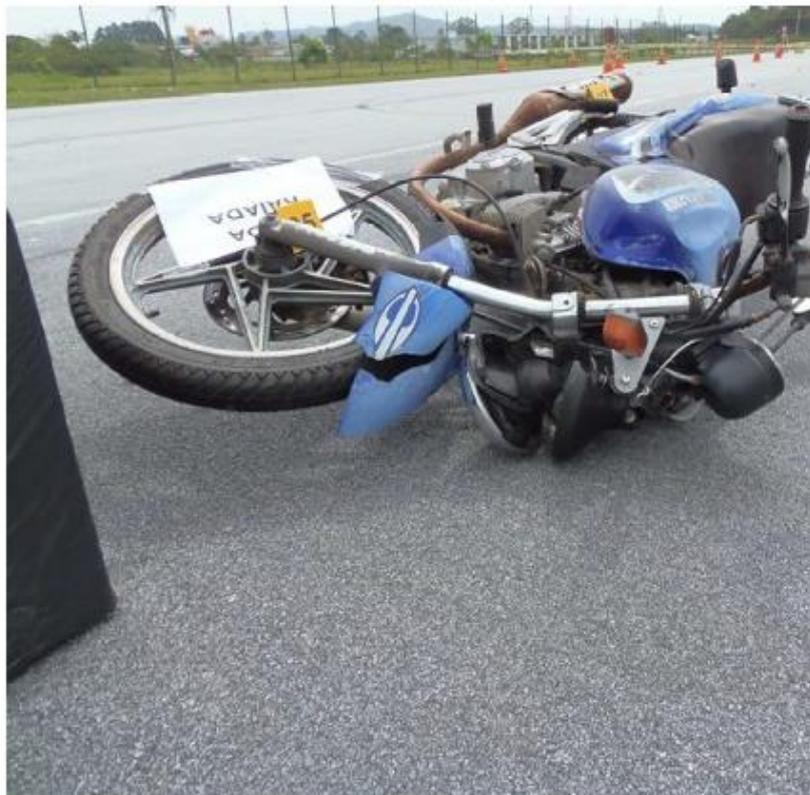
Fotografia 8— Danos V1 (para lama, farol, sistema de suspensão dianteiro)
