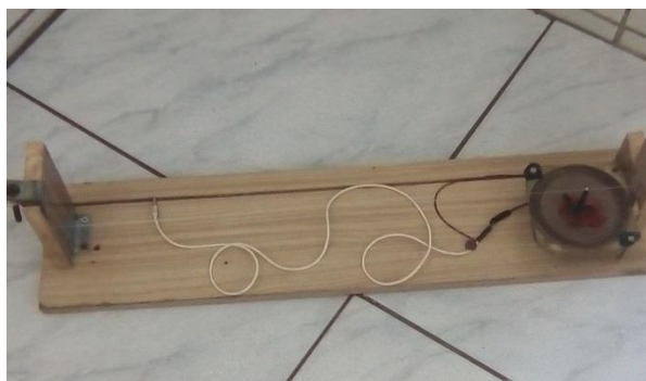
Figura 2: Gerador de ondas estacionárias. Fonte: os autores
