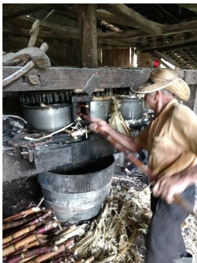
Imagem 09: Prensa da cana para obtenção do caldo utilizado para as produções no engenho Fonte: Autor (2017)
