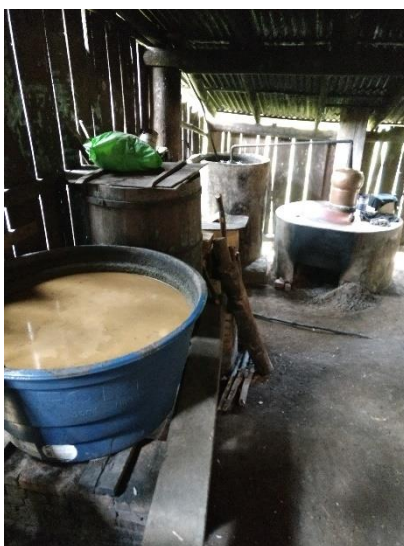
Imagem 10: Para a cachaça ocorre a fermentação do mosto por ao menos 1 dia Fonte: Autor (2017)
