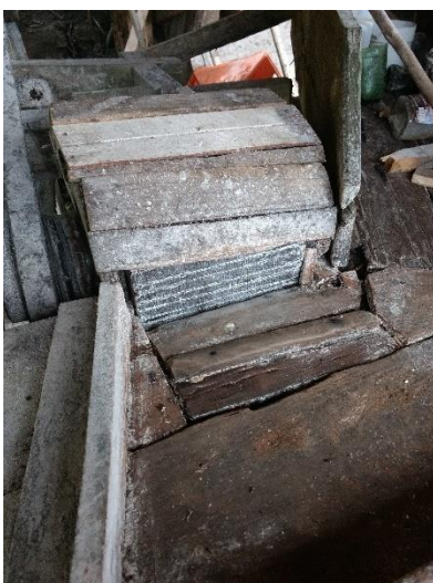
Imagem 05: A massa de mandioca é obtida através da rala da raiz Fonte: Autor (2017)
