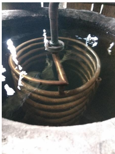
Imagem 12: O vapor produzido pela destilação é transmitido a serpentina, onde acontece o resfriamento e o vapor retoma estado líquido Fonte: Autor (2017)
