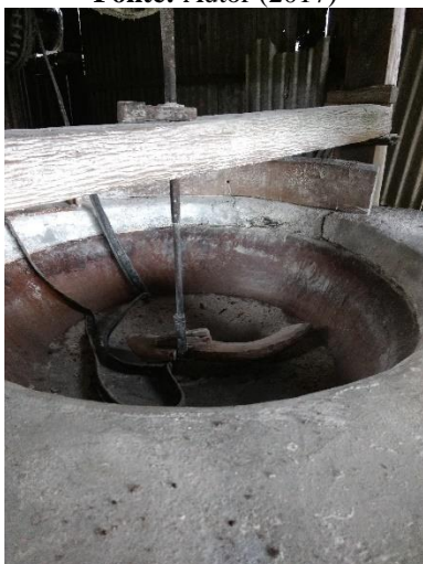
Imagem 07: A eliminação total da água e torrefação da mandioca ocorre no forno Fonte: Autor (2017)
