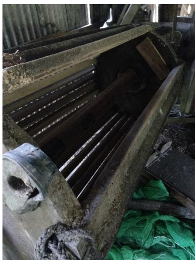
Imagem 04: Espaço onde ocorre a serva e lavagem da mandioca
