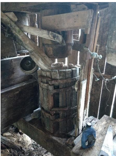
Imagem 06: A prensa faz a retirada da maior porção de água presente na massa de mandioca Fonte: Autor (2017)
