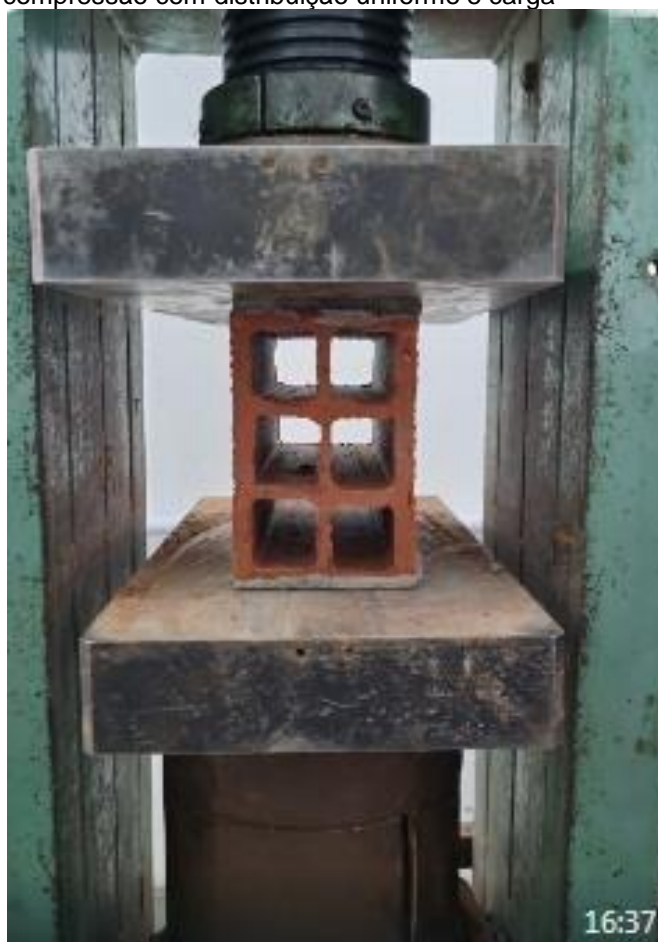
Figura 10 – Prensa de compressão com distribuição uniforme e carga
