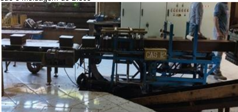
Figura 3 – Extrusão e Moldagem do Bloco
