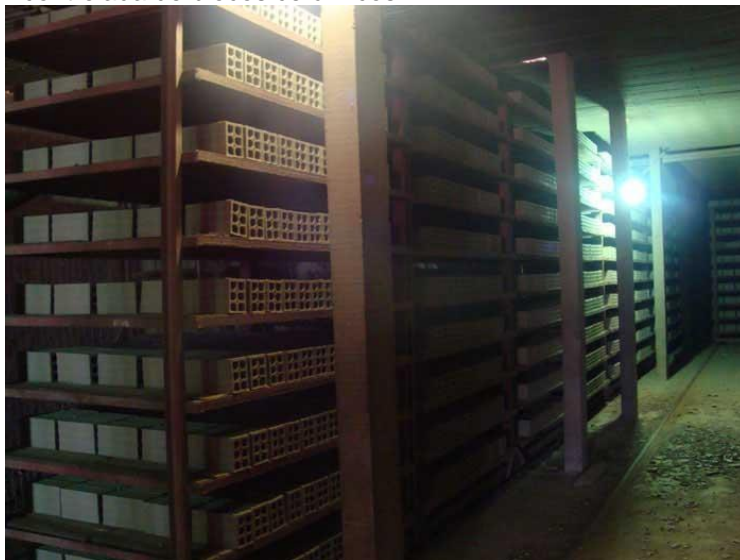
Figura 4 – Secagem controlada de blocos cerâmicos
