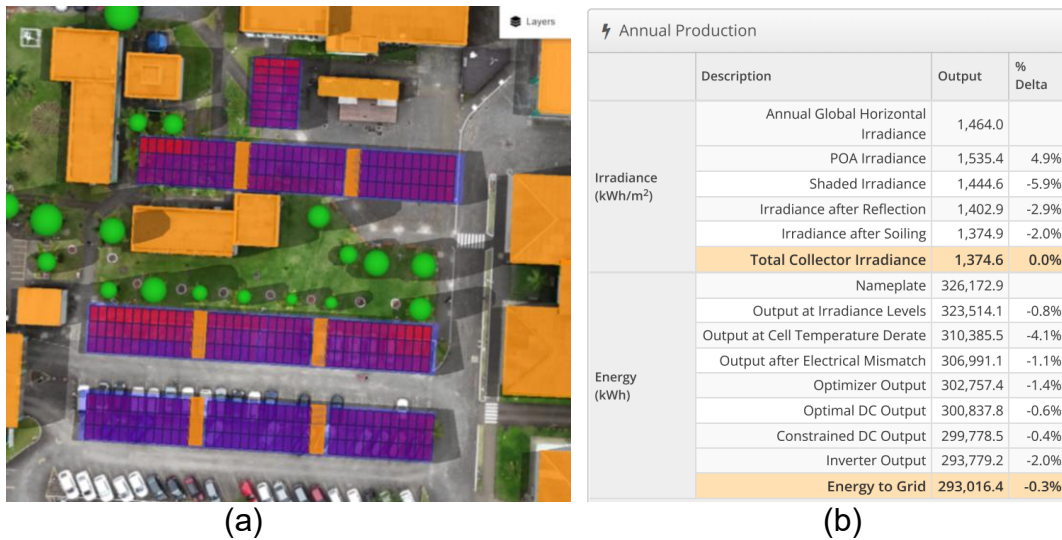
Figura 1 (a) – Impacto de sombreamento gerado no HelioScope®, impacto maior marcado com a coloração vermelha. (b) – Diagrama de perdas calculadas pelo mesmo software na simulação de energia exportada para a rede.
