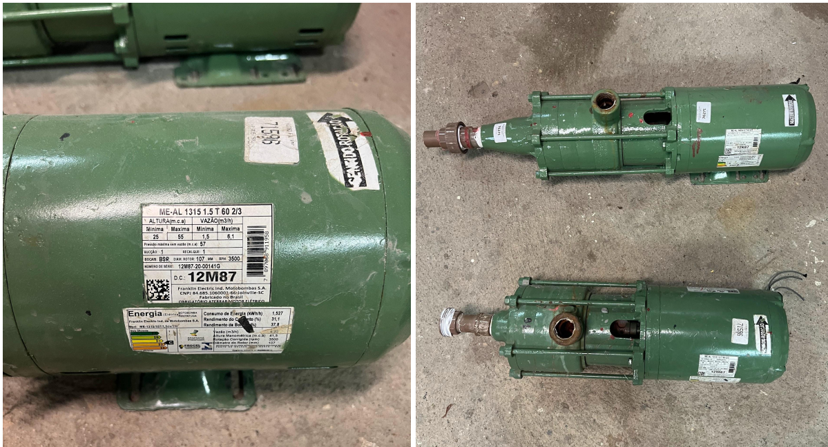
Figura 29 - Conjunto motobomba disponível para uso na instituição
