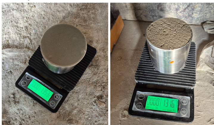
Figura 6 - Execução do ensaio de densidade de massa e teor de ar incorporado
