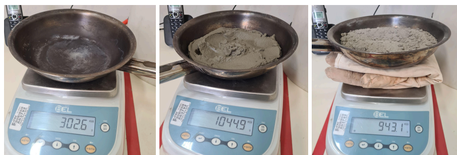
Figura 3 - Etapas do ensaio de teor de umidade por secagem ao fogo
