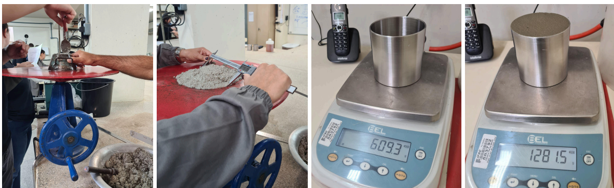
Figura 2 - (a) e (b) Ensaio do índice de consistência pela norma NBR 13276 (ABNT, 2016) e (c) e (d) Ensaio de densidade de massa e teor de ar incorporado
