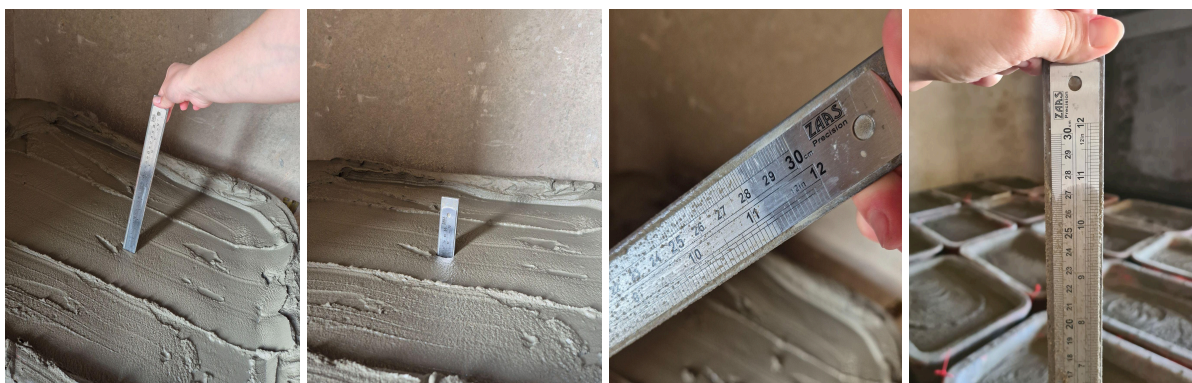
Figura 4 - Etapas da execução do ensaio de penetração com régua metálica (Casali et. al. , 2023)
