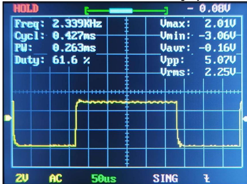
Figura 54 – Forma de onda na saída do sensor com gotejamento no sensor
