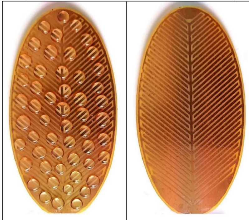
Figura 37 – Superfície do sensor desenvolvido molhada e seca, respectivamente
