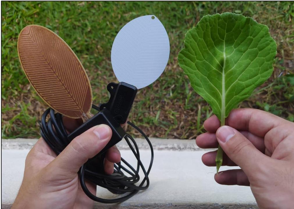
Figura 38 – Comparação entre as dimensões do sensor desenvolvido e do PHYTOS 31 com a folhagem da couve de folhas
