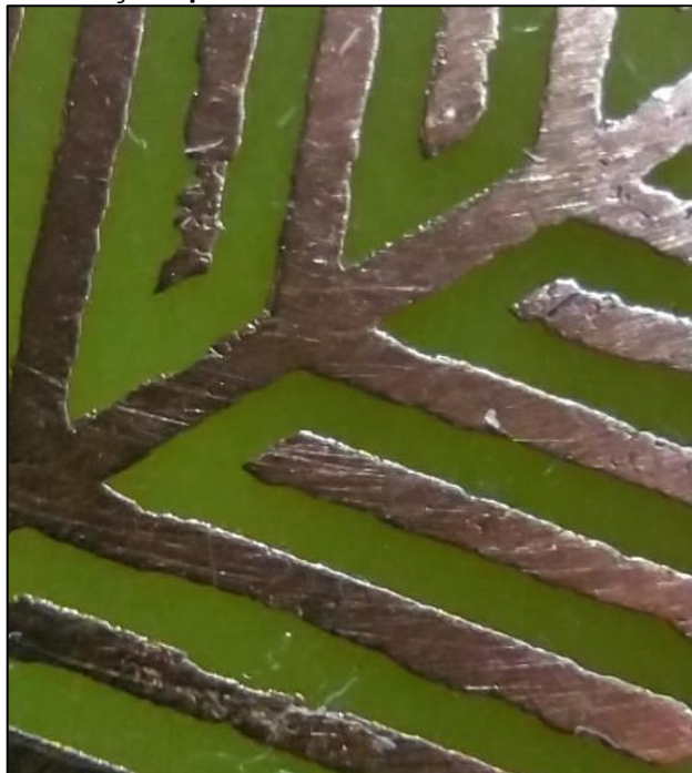
Figura 30 – Visualização aproximada nos eletrodos do sensor desenvolvido
