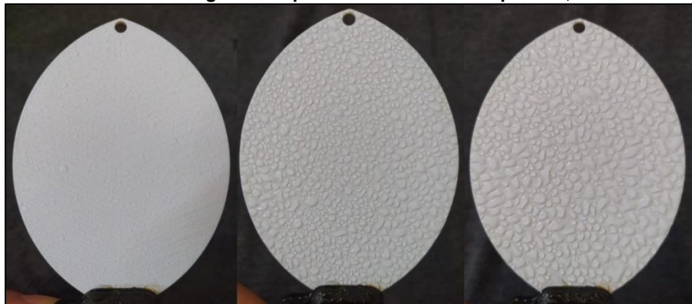
Figura 32 – Quantidade de água na superfície do PHYTOS 31 para 25, 75 e 125 borrifadas
