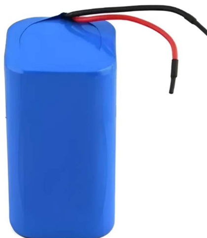
Figura 30 – Bateria de íon-Lítio 7,4V
