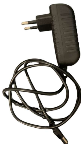
Figura 32 – Fonte de alimentação 12V
