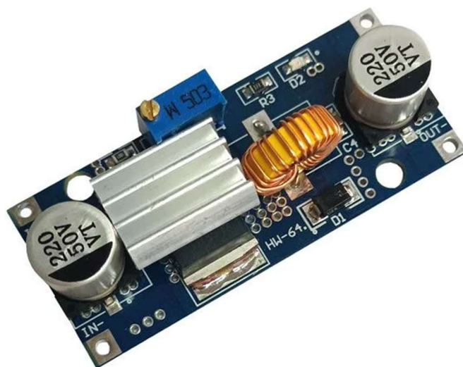
Figura 33 – Módulo Regulador de Tensão Step Down XL4015
