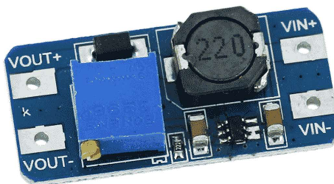
Figura 34 – Módulo Regulador de Tensão Step Up MT3608
