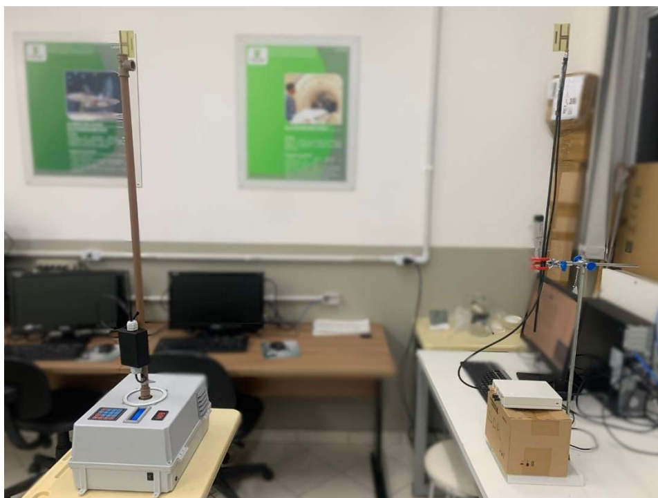
Figura 53 – Configuração ensaio antena Quasi-Yagi Uda distância de 100cm
