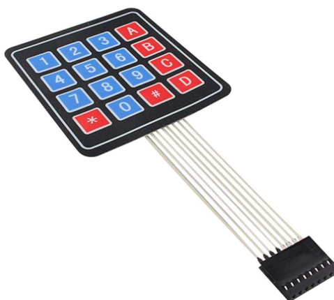
Figura 22 – Teclado Matricial de Membrana 4x4
