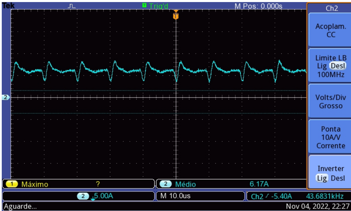
Fig. 49. Resultados práticos - corrente na saída ( Rshunt ) (Figura 18) com duty cycle de 9,8% e carga de 1 \Omega . Fonte: [18].
