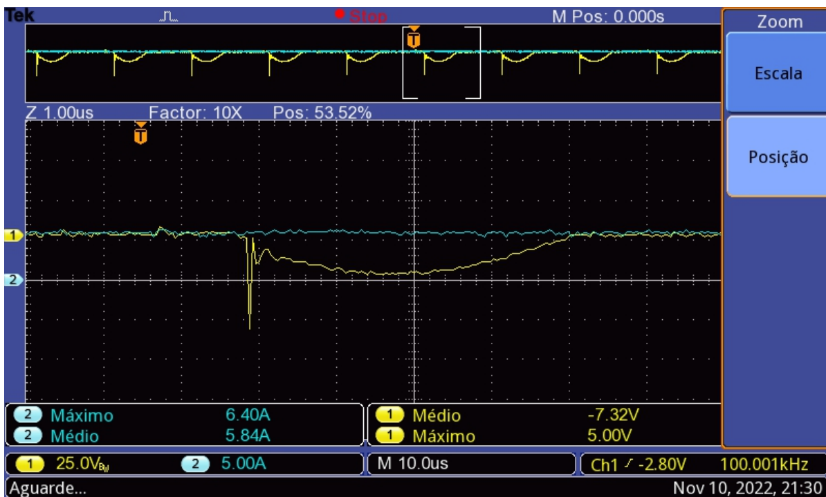
Fig. 47. Resultados práticos - queda de tensão no diodo de retificação do secundário D_6 (Figura 18) com duty cycle de 9,8% e carga de 1\ \Omega . Fonte: [18].
