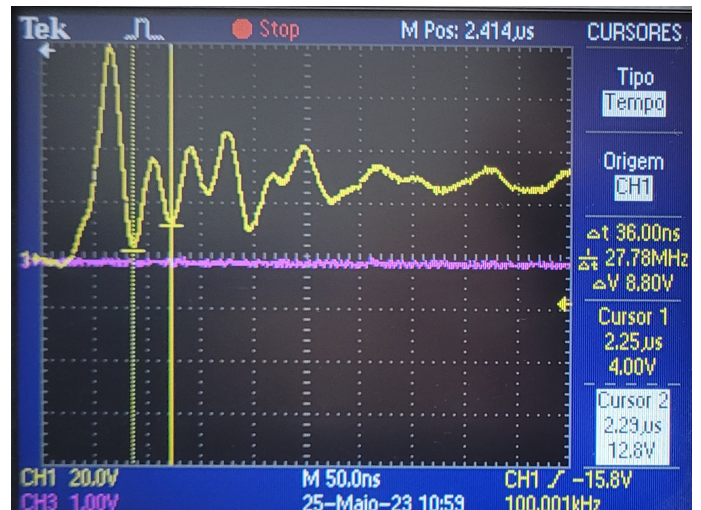
Fig. 29. Tensão obtida no resistor shunt com menor tempo de amostragem (amarelo). Fonte: Autoria própria.
