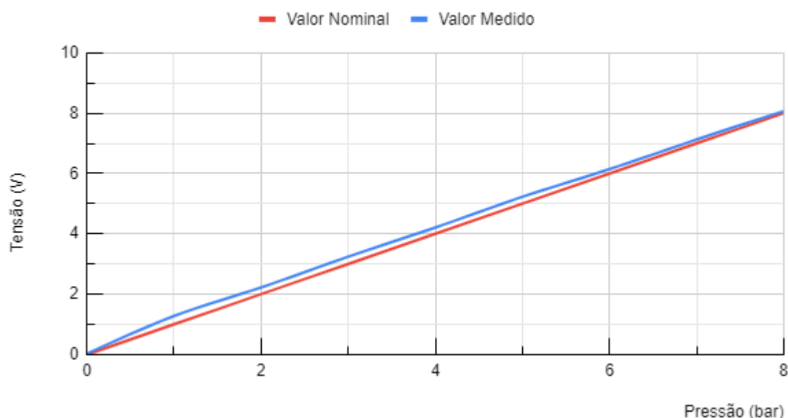
Figura 26 – Gráfico da comparação do sensor SDE 10-10V com o regulador de pressão novo Gráfico da comparação do Sensor De Pressão Festo 19562 SDE-10-10V x Regulador de pressão novo
