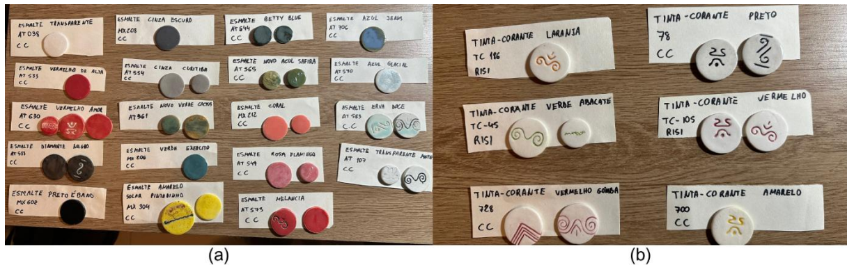
Figura 42 - Teste de esmalte a) Esmaltes; b) Tintas-corantes
