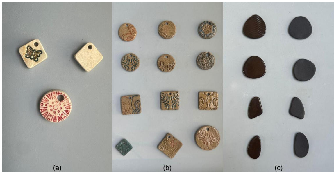
Figura 31 - Testes de massas cerâmicas: a) Argila Bianca Pascoal; b) Argila Shoko Pascoal; c) Argila Preta Argila & Cia
