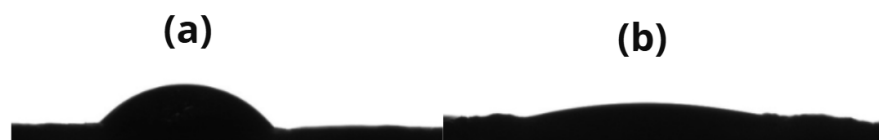
Figura 5 - Molhabilidade das membranas sem nQS (a) e com nQS (b)
