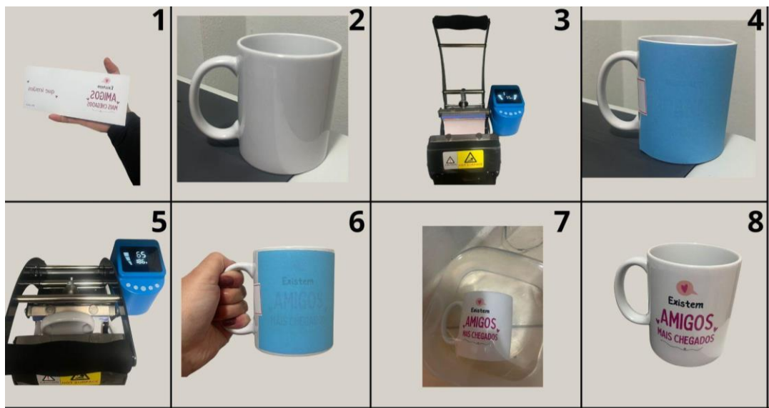
Figura 10 - Sequência do processo de personalização de canecas por sublimação
