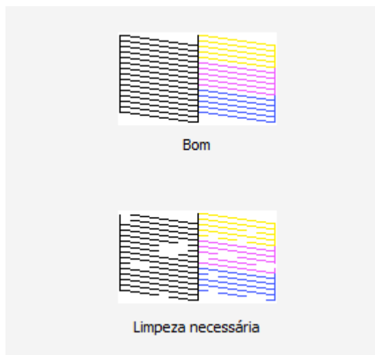
Figura 1 - Verificação visual da limpeza dos bicos
