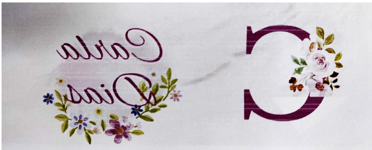
Figura 30 - Impressão após 2ª tentativa de entupimento forçado
