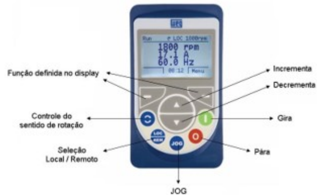
Fig. 1. Interface homem-máquina do inversor de frequência CFW11 do fabricante WEG [8].
