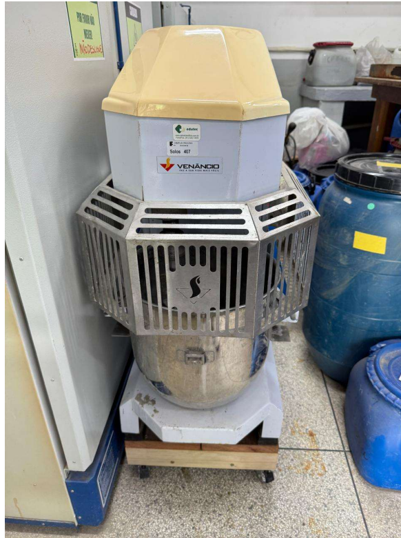
Figura 03 – Argamassadeira utilizada para mistura
