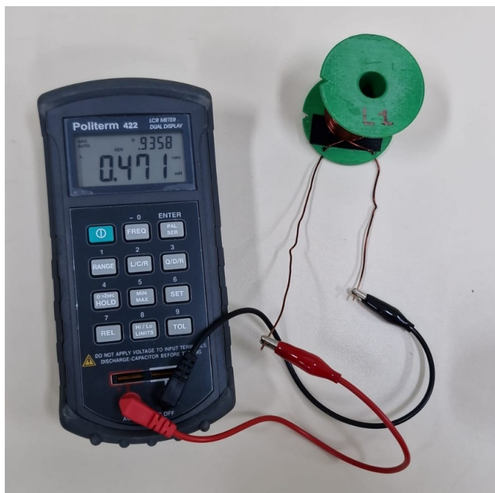
Figura 10 – Medição da indutância em L1.
