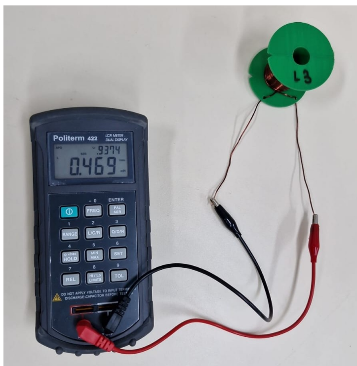
Figura 12 – Medição da indutância em L3.
