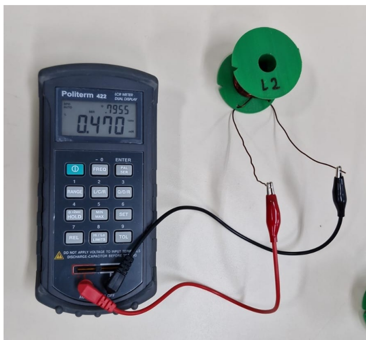
Figura 11 – Medição da indutância em L2.
