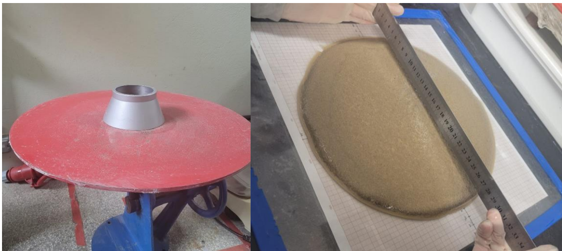
Figura 6 – (a) exemplo de mesa onde é realizado o ensaio, (b) realização do ensaio com a medição do índice de consistência
