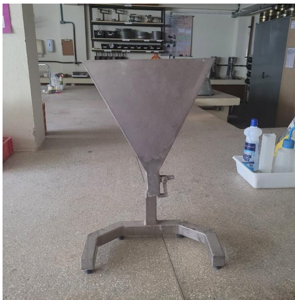
Figura 7 – Mini Funil V para argamassas autoadensáveis
