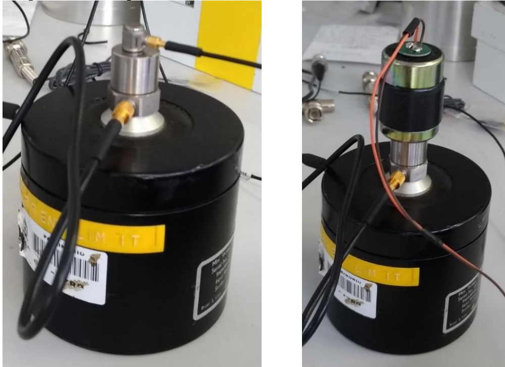
Figura 21 – Montagem back to back dos sensores e do excitador eletrodinâmico
