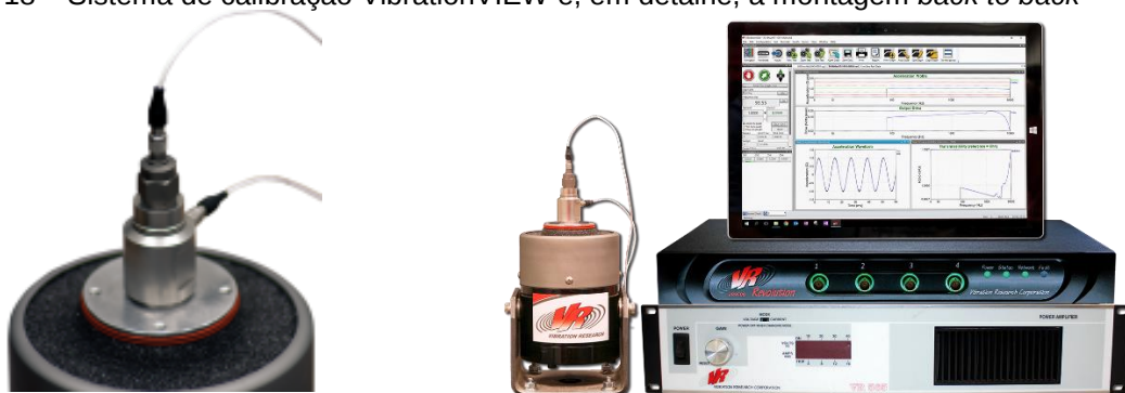
Figura 18 – Sistema de calibração VibrationVIEW e, em detalhe, a montagem back to back
