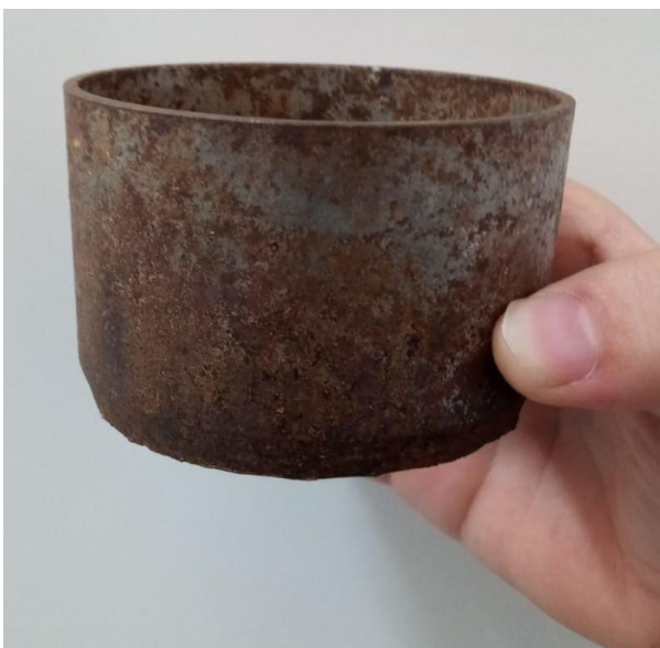
Figura 11 – Anel volumétrico para a retirada das amostras.
