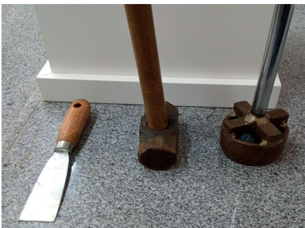
Figura 12 – Equipamentos auxiliares na coleta das amostras: espátula, marreta e anel fixado com barra de ferro.
