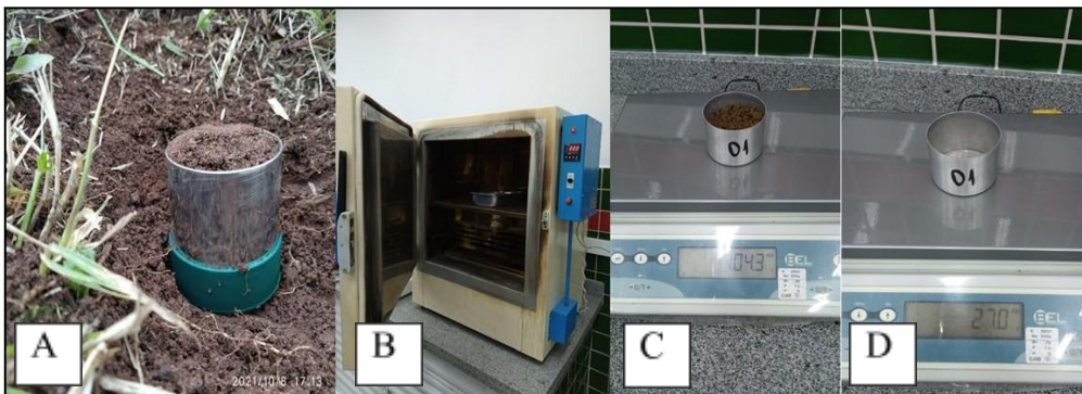
Figura 20 – Coleta, secagem e pesagem do solo para definição da umidade do solo.
