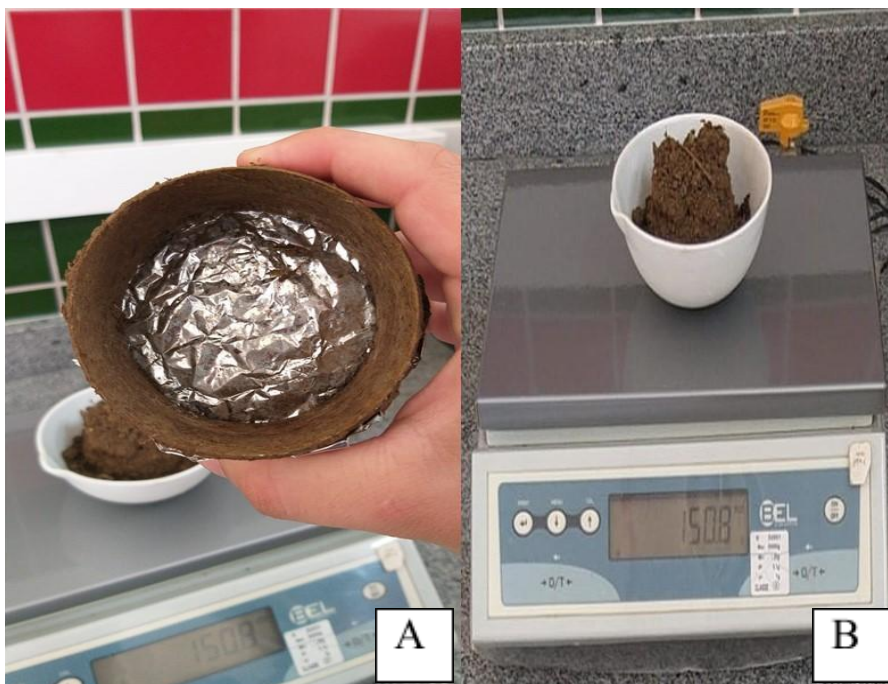
Figura 15 – Remoção do solo do anel volumétrico e pesagem na balança analítica.
