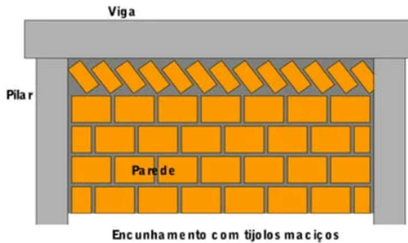
Figura 52 - Encunhamento por meio de tijolos cerâmicos maciços.
