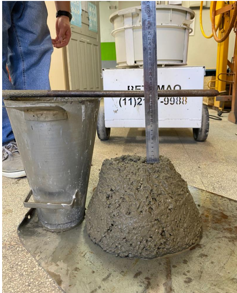
Figura 24 - Resultado do ensaio de abatimento de tronco de cone
