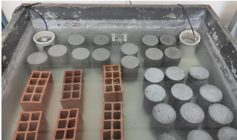
Figura 25 - Tanque de cura com os corpos de prova de concreto
