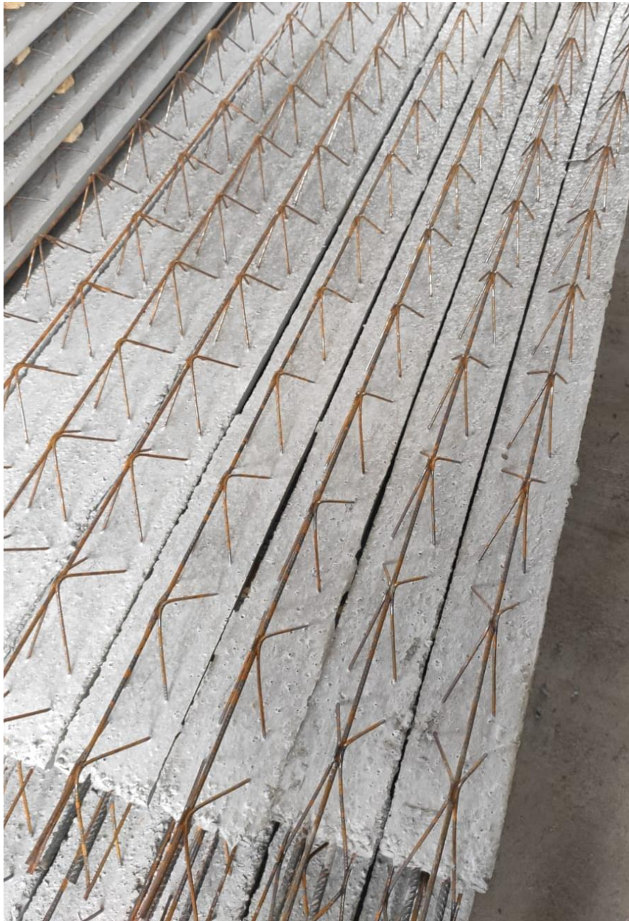
Figura 16 - Acabamento da parte superior das vigotas treliçadas
