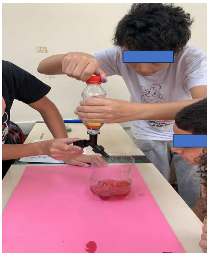
Figura 4. Utilização do objeto reciclado como funil de separação ou decantação (funil de bromo) usado na separação líquido-líquido.
