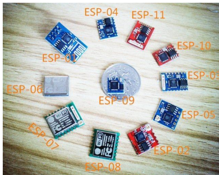
Figura 6 – As variantes do ESP8266.
