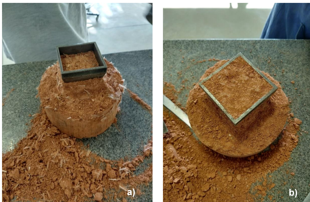
Figura 39 - a,b) Corpo de prova para moldagem ensaio de cisalhamento
