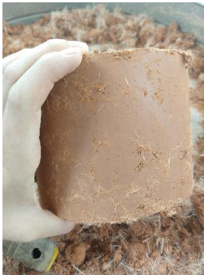
Figura 34 - Corpo de prova moldado com o compactador motorizado Contenco
