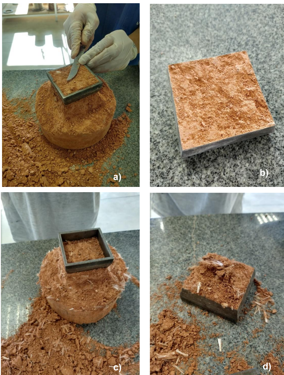
Figura 42 - a, b, c e d) Moldagem dos corpos de prova cúbicos
