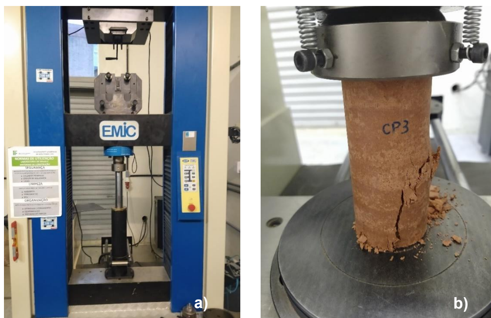
Figura 40 - a) Prensa EMIC DL30000 e b) corpo de prova
