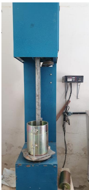
Figura 33 - Compactador motorizado de Proctor e CBR Contenco
