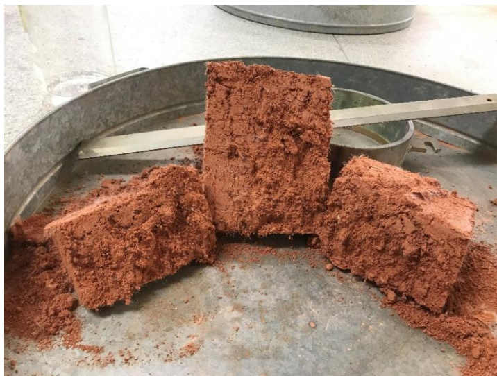
Figura 35 - Corpo de prova após pesagem e retirada de amostras
