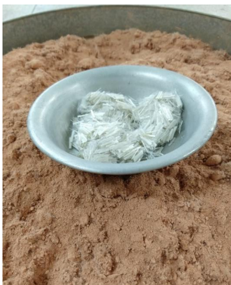
Figura 36 - Homogeneização da mistura solo-fibra
