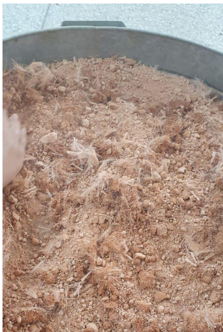
Figura 37 - Homogeneização da mistura solo-fibra
