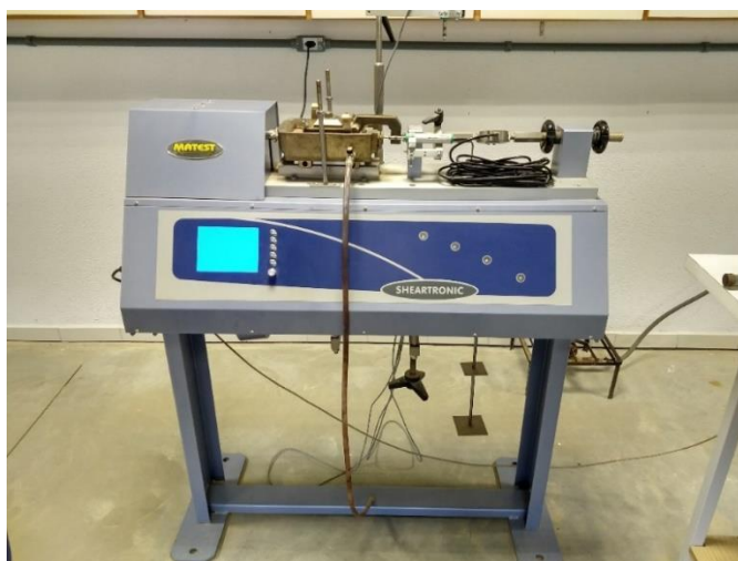
Figura 45 - Equipamento de cisalhamento direto Matest
