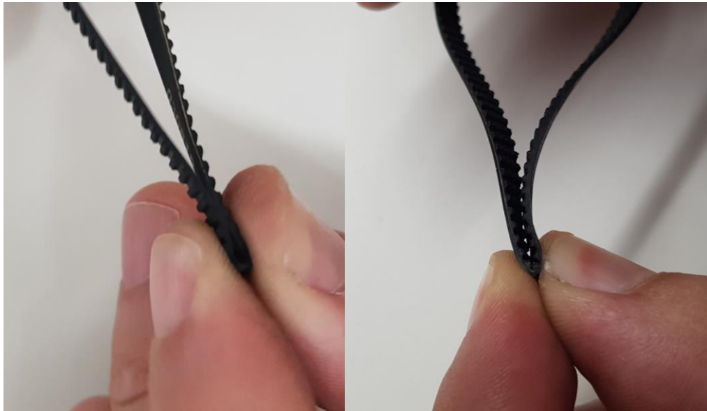
Figura 48 – Realização de vincos nos dentes das correias
