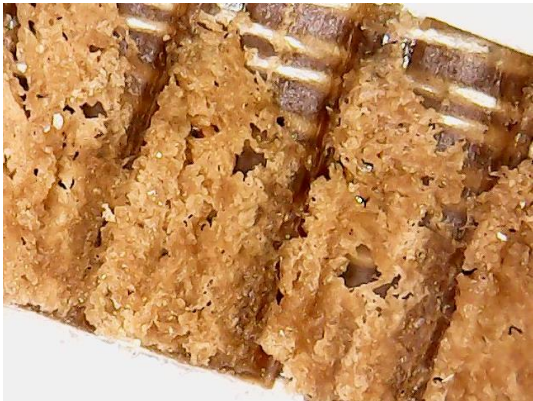
Figura 43 - Dentes totalmente danificados após teste no aparato (Aumento 20X)
