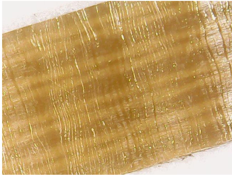
Figura 38 – Alteração insignificante no dorso da correia TWbelt após o teste (Aumento 20X)
