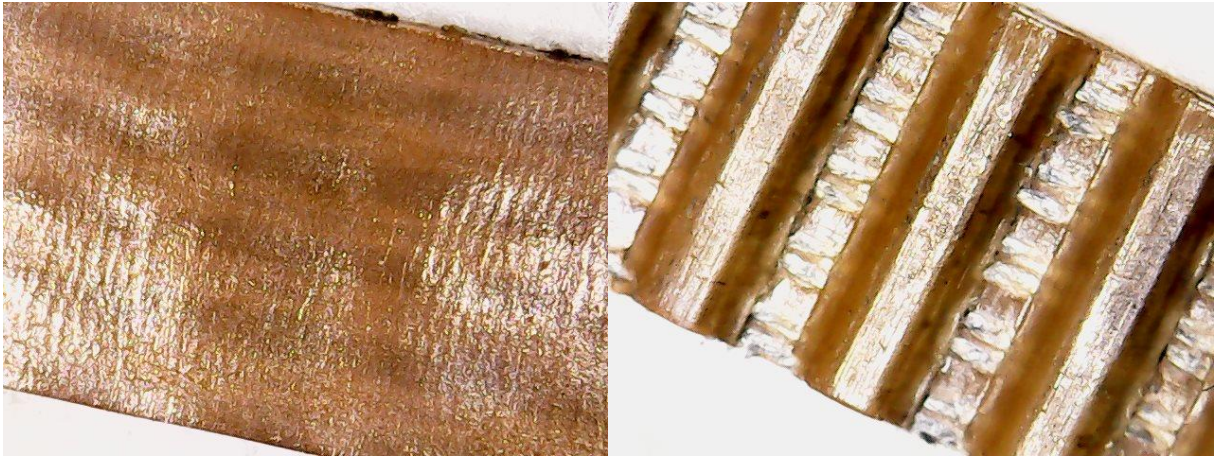
Figura 50 - Faces da correia TWBELT após o teste com correia vincada
