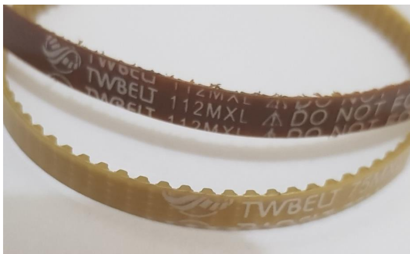
Figura 41 - Alteração de tonalidade após exposição a temperaturas altas
