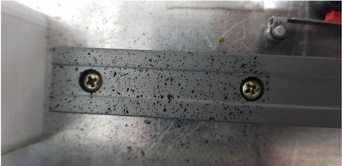
Figura 45 - Evidência de desgaste da correia em teste no equipamento
