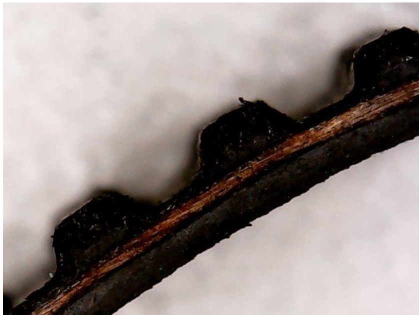
Figura 37 - Cordões de tração expostos pelo desgaste após o teste (Aumento 20X)
