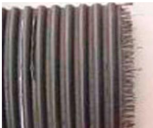
Figura 6- Exemplo de falha por vinco
