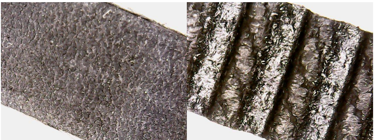
Figura 49 - Faces da correia Continental sem indícios de desgaste após teste com correias viciadas
