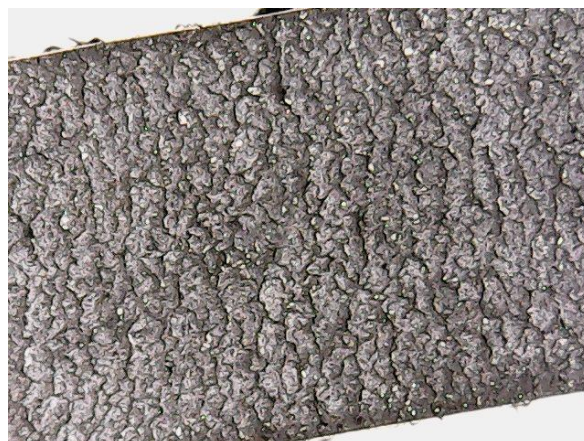
Figura 35 - Dorso correia Continental após teste de ciclagem simples e câmara climática (Aumento 20X)
