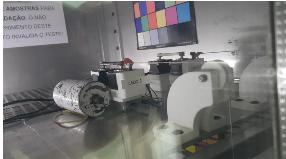
Figura 34 – Realização do ensaio no interior da câmara climática
