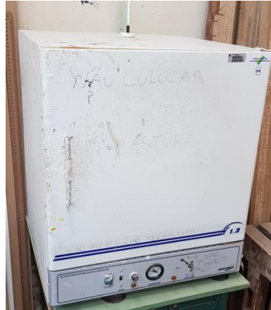
Figura 40 - Estufa utilizada para expor as correias a altas temperaturas
