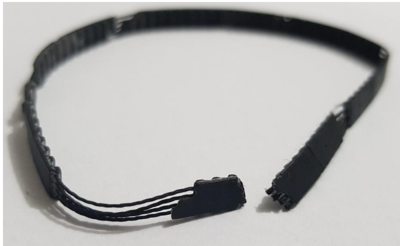
Figura 25 - Correia danificada após uso em campo
