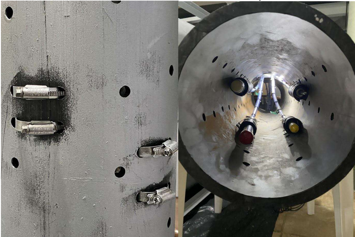
Figura 21 - (a) Abraçadeira de inox para fixação dos sensores e (b) Sensores fixados no interior do tubo (c) Sensores revestidos de borracha para fixação e cabos por mangueira (d) Saída dos cabos dos sensores do tubo)
