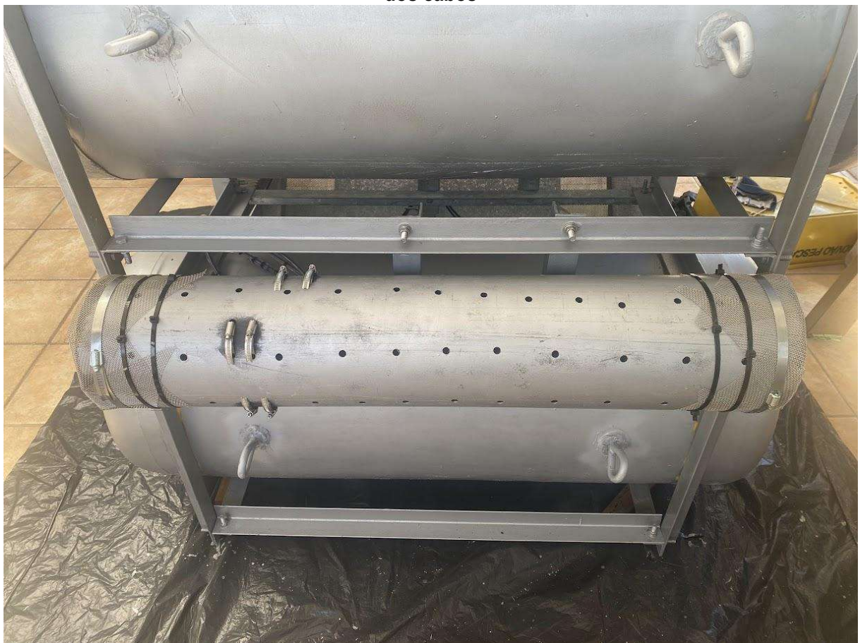
Figura 22 – (a) Fixação do tubo com sensores e cabos na parte inferior da estrutura da Estação; (b) Tubo de saída dos cabos dos sensores para o Data Logger ; (c) Tubo de proteção dos cabos
