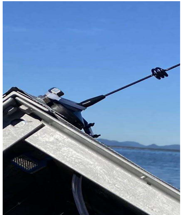
Figura 25 - (a) e (b) Fixação da antena externa do modem
