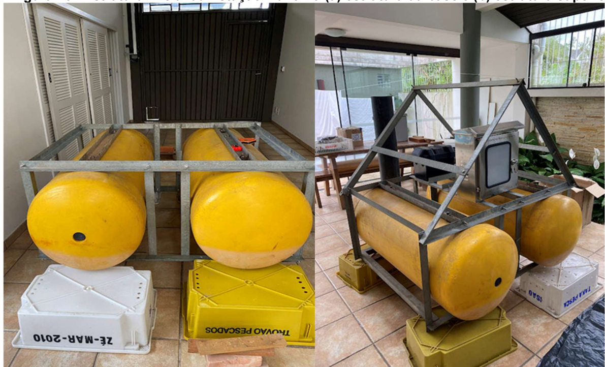
Figura 16 - Estrutura inicial da Estação Marítima (a) estrutura da base e (b) estrutura superior
