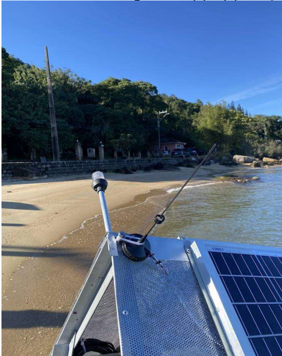
Figura 25 - (a) e (b) Fixação da antena externa do modem
