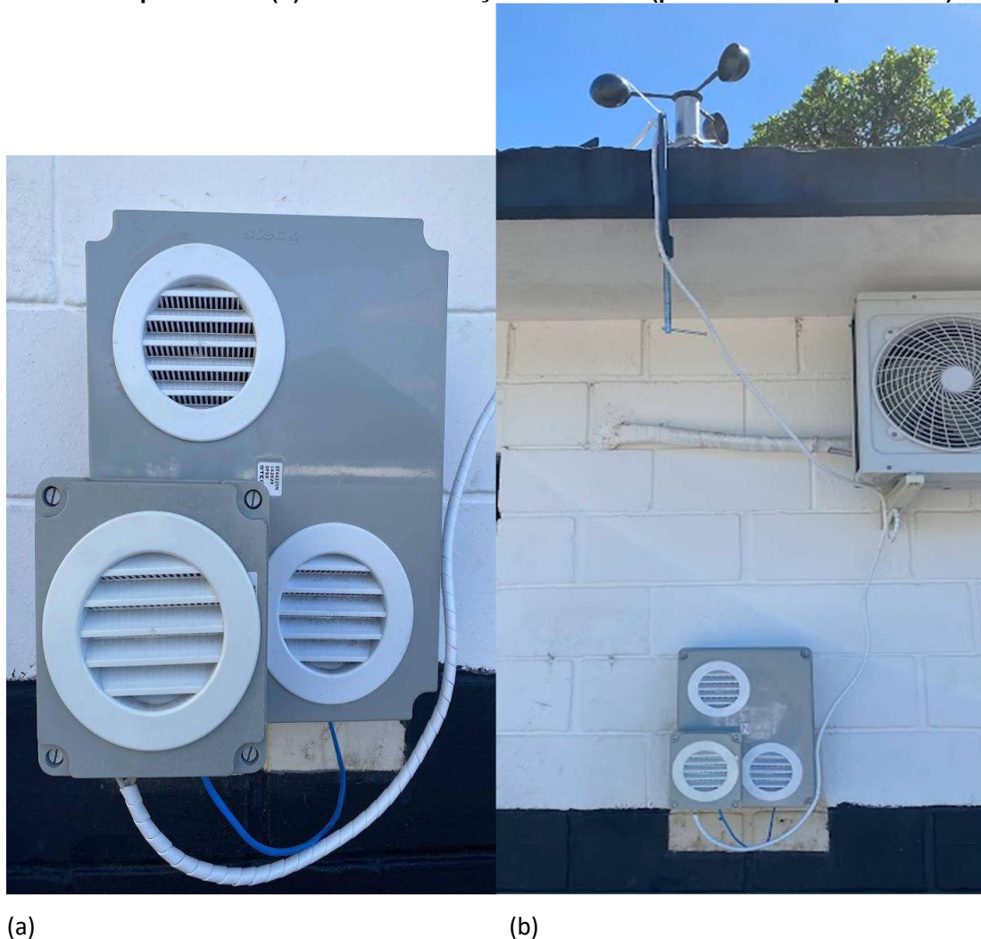
Figura 8 - Imagens do protótipo da Estação Meteorológica instalada em campo (a) caixa protetora e (b) local de instalação dos testes (parede voltada para o sul)
