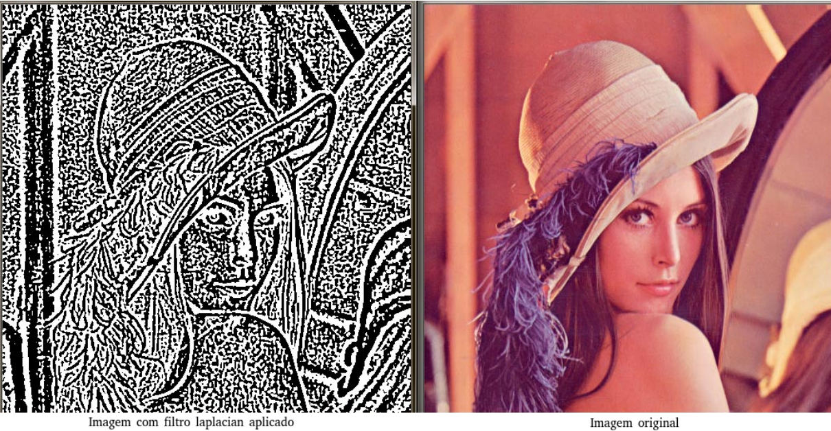
Figura 5 – Exemplo de filtro Laplacian - Filtrada esquerda e original a direita
