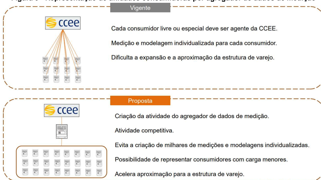
Figura 9 - Representação de unidades consumidoras por agregador de dados de medição
