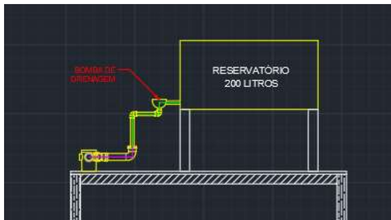
Figura 42 – Localização da bomba - pavimento transição
