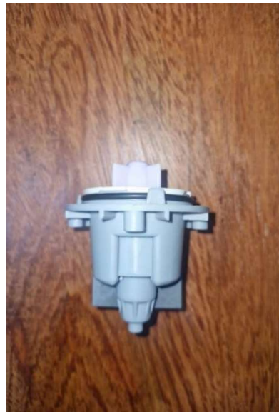
Figura 38 – Bomba de drenagem vista frontal
