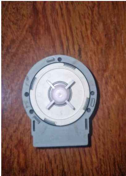
Figura 39 – Bomba de drenagem vista superior
