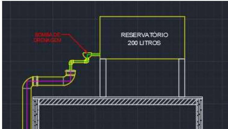
Figura 41 – Localização da bomba - pavimento superior
