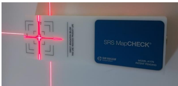
Figura 22 - Matriz de diodos SRS MapCHECK, da Sun Nuclear utilizada neste estudo
